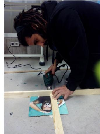
Imagen 38. Unión de los listones mediante tornillos.
