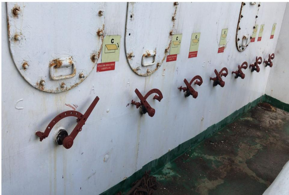
*Ilustración 51. Pantallas cortafuegos manuales. Fuente: Trabajo de campo*
