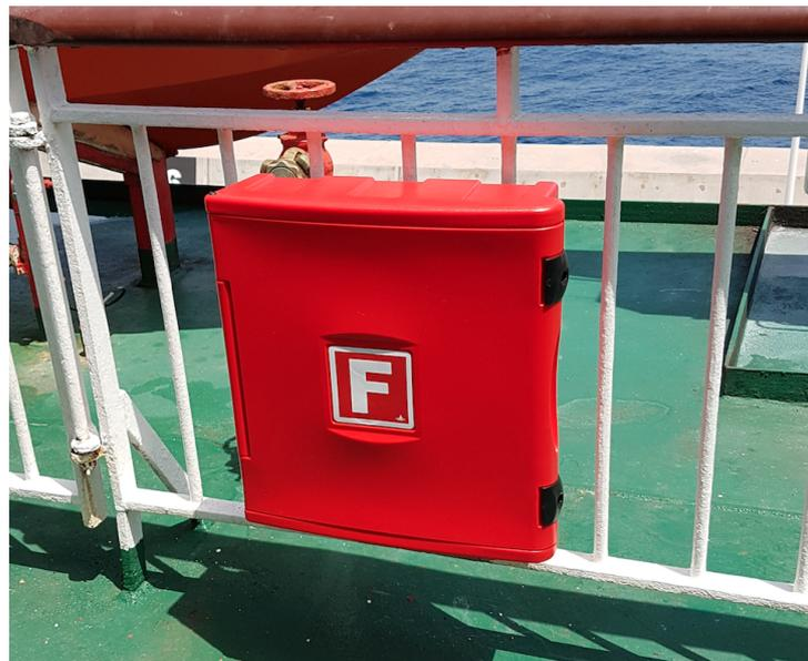
*Ilustración 21. Caja contra incendios para manguera de intemperie. Fuente: Trabajo de campo*
