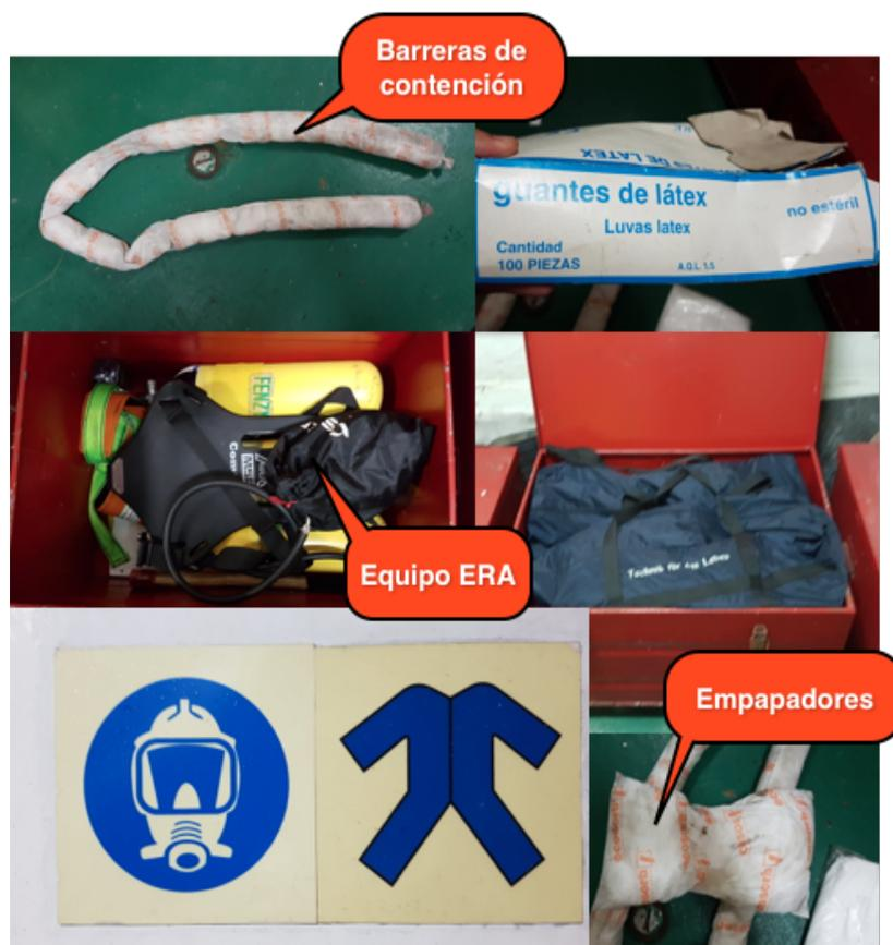
Ilustración 56. Material del SOPEP. Fuente: Trabajo de campo
