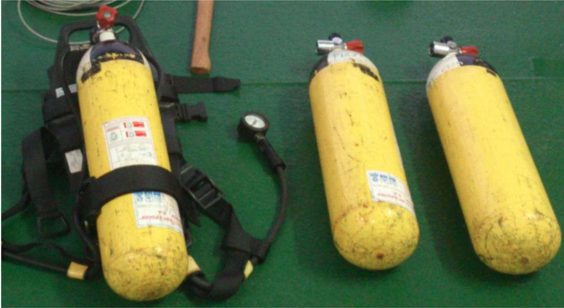
*Ilustración 53. Equipo de respiración autónoma (ERA). Fuente: Trabajo de campo*
