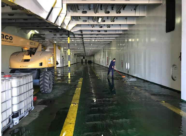
*Ilustración 15. Cubierta nº3, después de disparo de rociadores. Fuente: Trabajo de campo*
