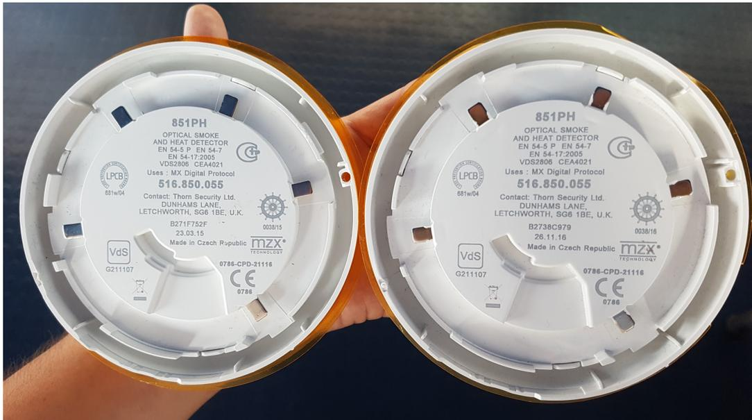
*Ilustración 29. Detectores de humo y calor. Fuente: Trabajo de campo*
