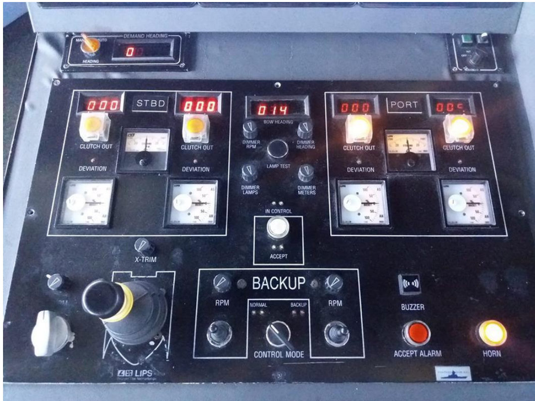
Ilustración 50: Consola de Maniobra Volcán de Teno. Fuente: Capitán Volcán de Teno
