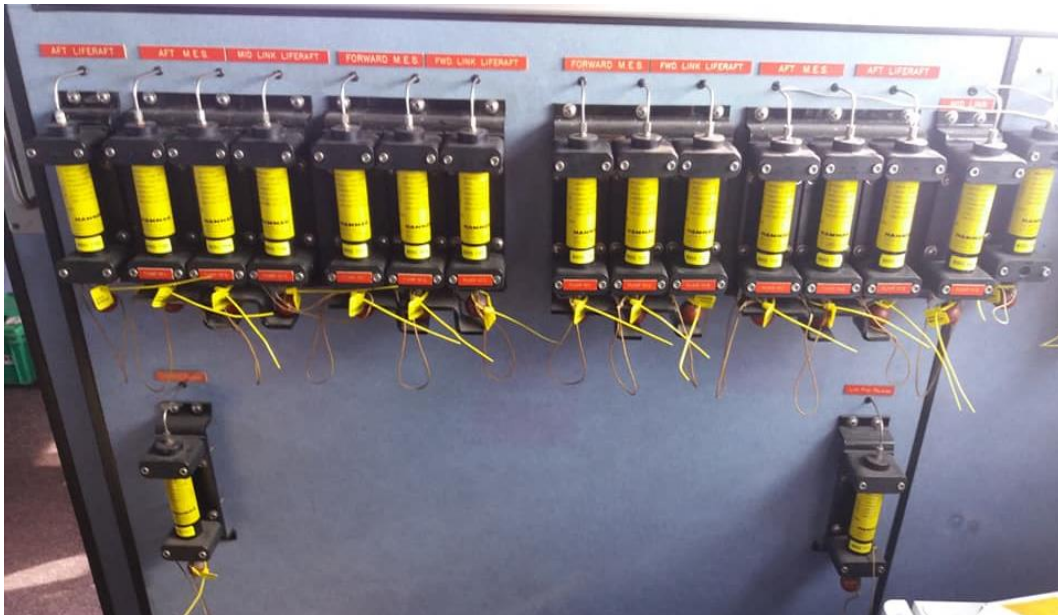
Ilustración 24: Bombas de Vacío de los MES. Fuente: 1º Oficial Volcán de Teno
