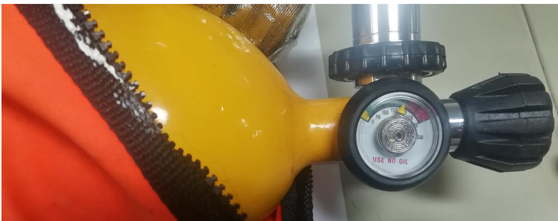
Ilustración 99. Manómetro del AREE. Fuente propia.
