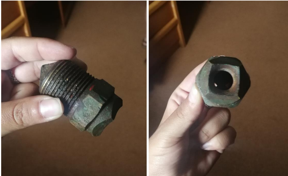
Ilustración 50. Boquilla de los rociadores de garaje. Fuente propia.
