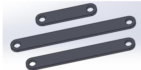
Figura 11: Dimensiones manivela, biela y balancín (Izquierda) y modelo 3D manivela, biela y balancín (Derecha). Fuente propia
