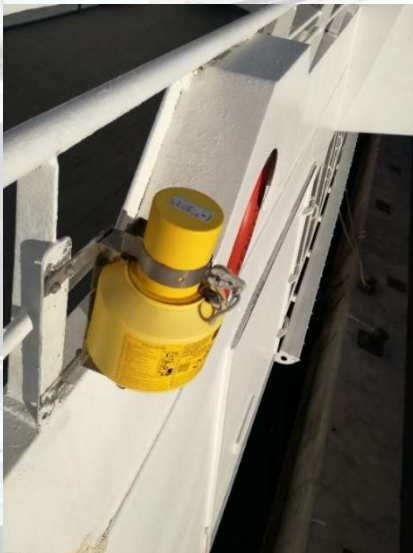
Fotos: Aro con señal fumígena y luz alerón Babor. Elaboración propia
