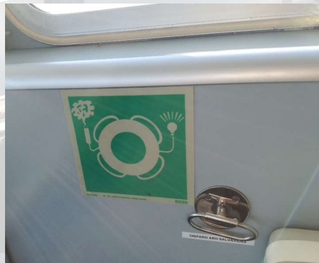
Fotos: Aro con señal fumígena y luz alerón Babor. Elaboración propia
