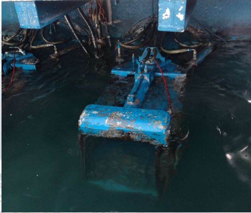
Foto: Waterjet banda estribor. SOME. Elaboración propia
