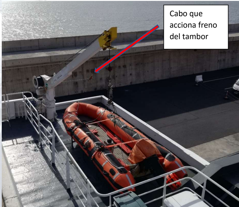
Foto: Pescante y bote de estribor. Elaboración propia
