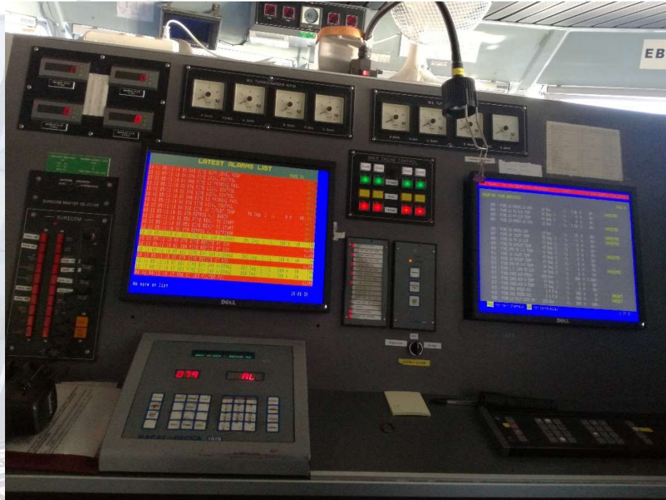
Foto: Vista principal puesto jefe de máquinas. Elaboración propia
