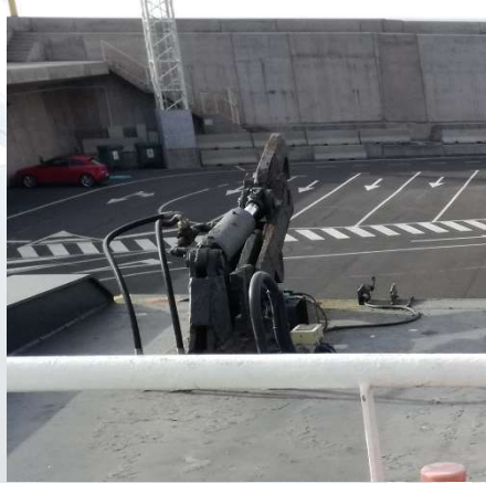
Foto: Trinca superior de la rampa de popa. Elaboración propia
