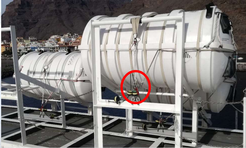
Foto: contenedor balsas estibado en su plataforma. Elaboración propia
