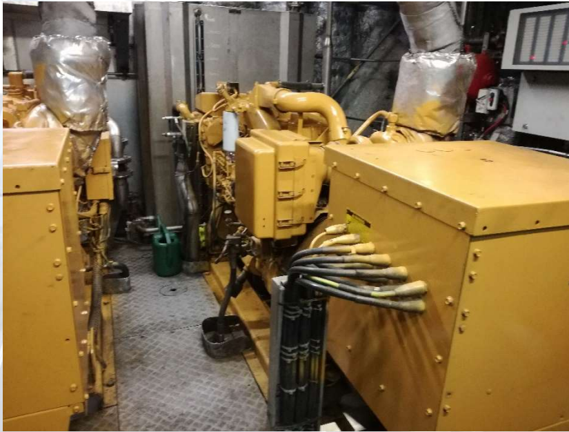
Foto: Motores auxiliares patín de babor. Elaboración propia
