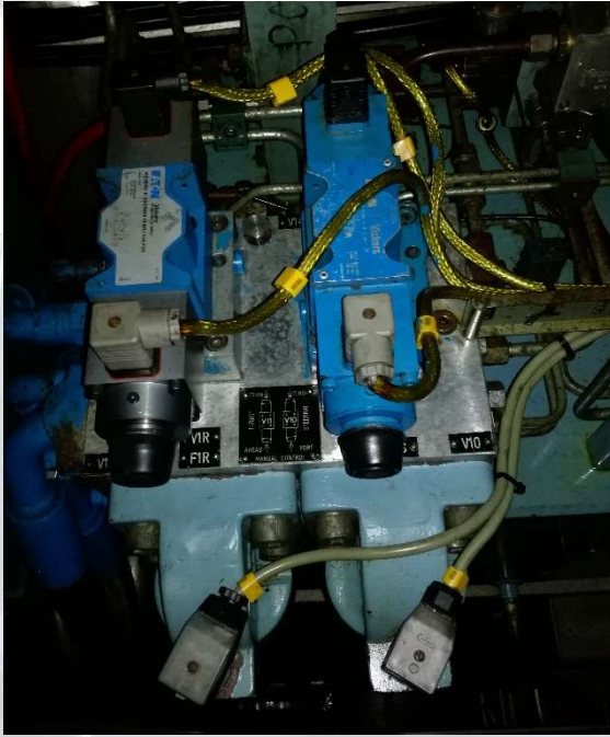
Foto: Electrovalvulas bucket (babor) y steering (estribor). Elaboración propia
