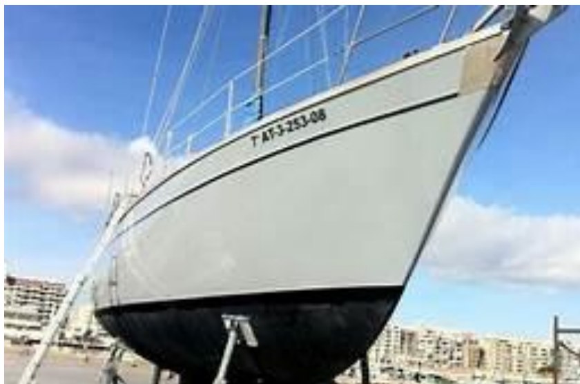
Ilustración 10: Casco de fibra de vidrio. Fuente: https://uk.images.search.yahoo.com/search/images
