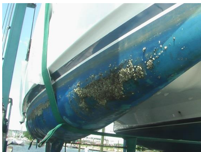
Ilustración 11: Incrustación en el casco. Fuente: https://uk.images.search.yahoo.com/search/images
