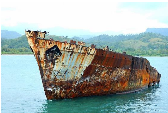
Ilustración 12: Ejemplo de corrosión de casco. Fuente: https://uk.images.search.yahoo.com/search/images
