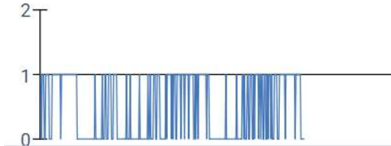
Figura 27. Señal PWM generada con Arduino conectada al transistor Q6.
