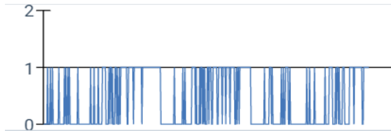
Figura 28. Señal PWM generada con Arduino conectada al transistor Q5.
