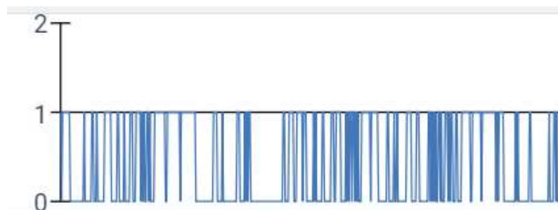
Figura 29. Señal PWM generada con Arduino conectada al transistor Q2.
