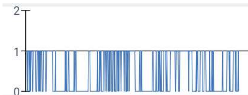
Figura 32. Señal PWM generada con Arduino conectada al transistor Q4.
