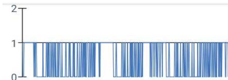
Figura 39. Señal PWM generada con Arduino y optoacoplada, esta señal varía entre 0 y 1 pues TinkerCAD (la herramienta utilizada) solo permite estos dos valores. Esta salida se corresponde con la conectada al transistor Q5.
