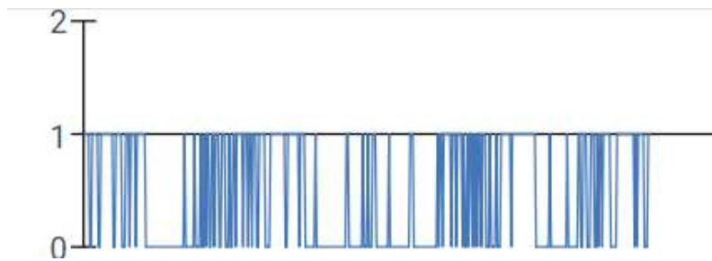
Figura 30. Señal PWM generada con Arduino conectada al transistor Q1.
