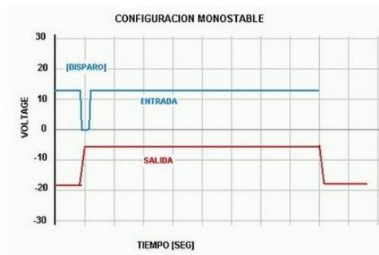
FIGURA VI - 10 – FUNCIONAMIENTO DEL NE555 EN CONFIGURACIÓN MONOSTABLE
