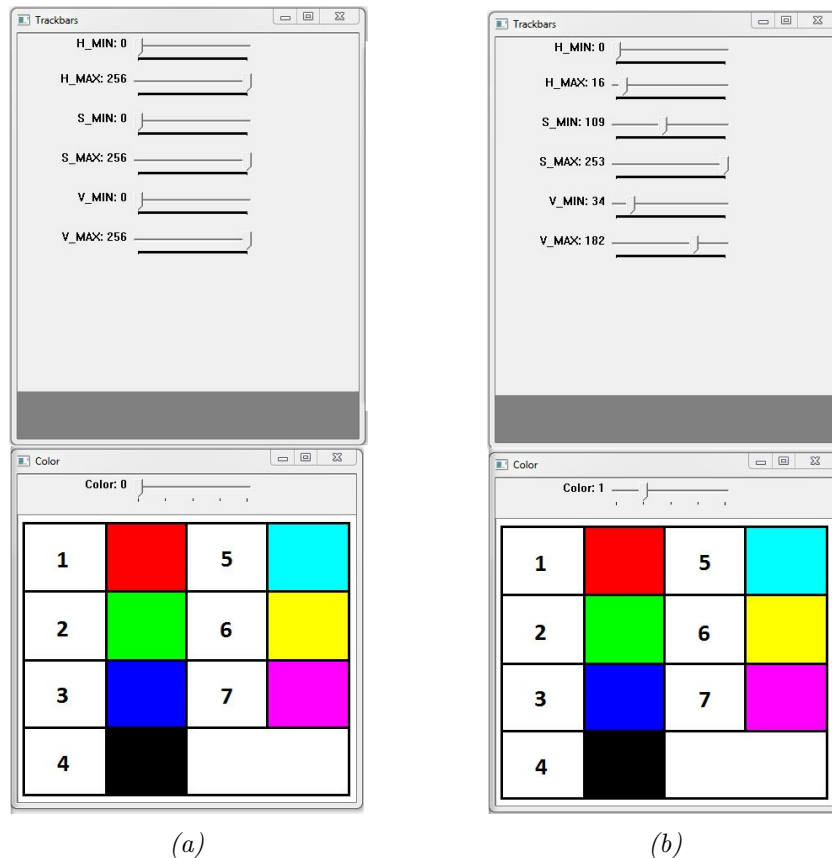
Figura 27: a) Selector de colores a 0 con parámetros no inicializados. b) Selector de colores a 1 con parámetros HSV para el color rojo.
