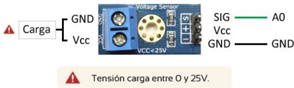
Figura 4.19: Esquema de conexión sensor de voltaje
