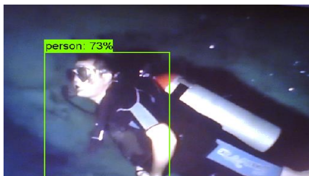
Figura 8.26: Detección de objetos usando TensorFlow con mobilenet
