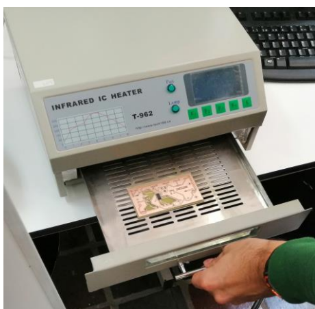
Figura 6.20: PCB en el horno con los componentes SMD soldados
