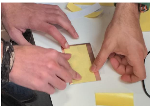
Figura 6.8: Fijación del fotolito a la placa de cobre
