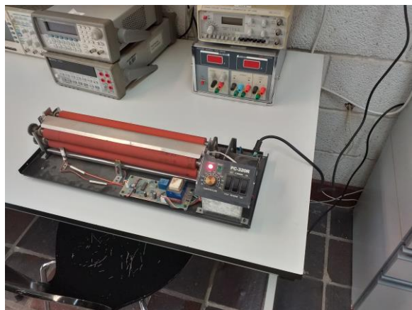
Figura 6.7: Plastificadora utilizada para que el fotolito quede adherido a la placa de cobre
