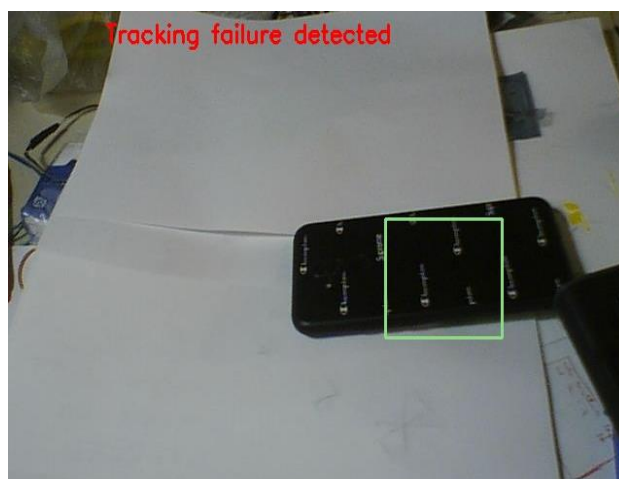
Figura 8.8: Respuesta del algoritmo KCF tras tapar el objeto de interés
