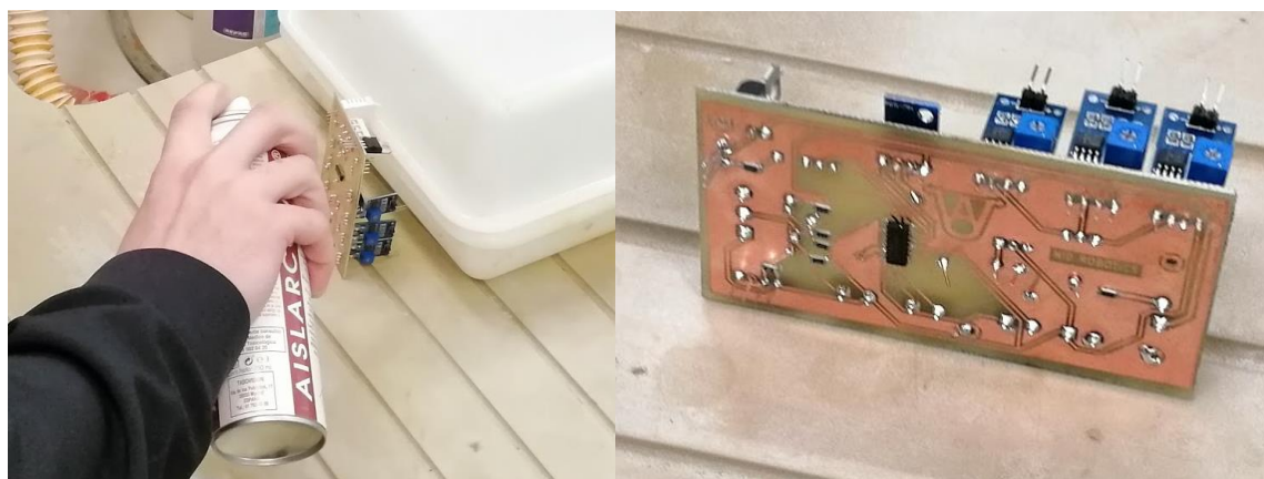
Figura 6.24: Puesta de laca en la PCB para evitar oxidación y desgaste en general
