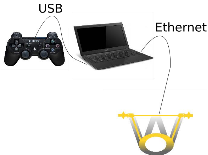
Figura 2.2: Conexión del sistema
