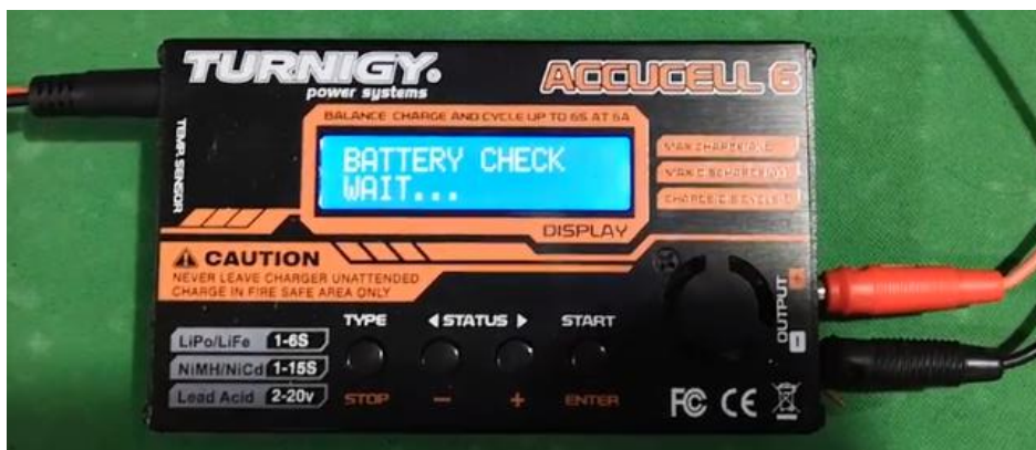
Figura 7.9. Comprobación del correcto estado de la batería
