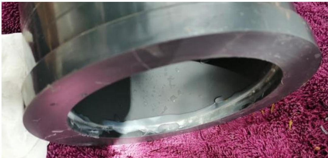
Figura 4.6. Silicona en estado sólido
