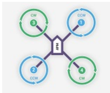
Figura 6.25. Configuración de los motores en un quadcopter
