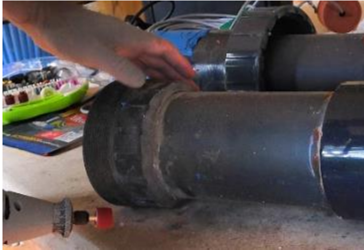
Figura 4.8. Rebajado del material
