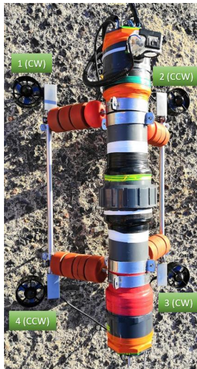
Figura 6.26. Configuración de los motores en nuestro prototipo
