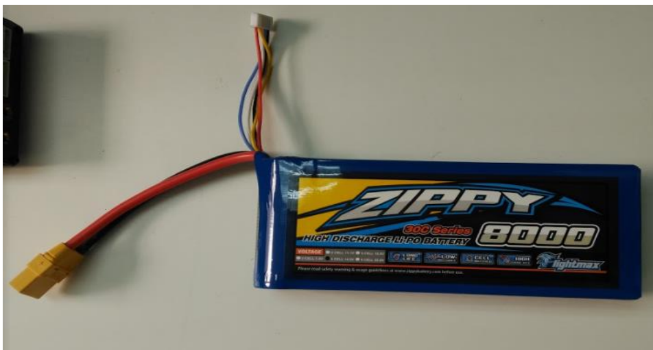
Figura 7.4. Batería LiPo de 8000 mAh empleada
