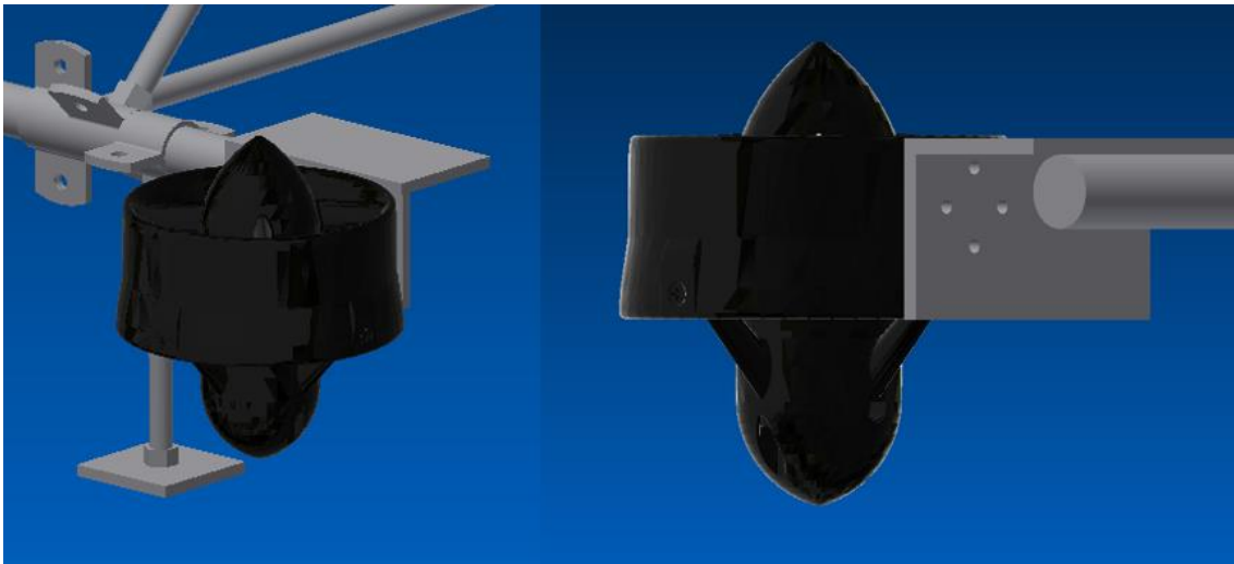
Figura 3.6. Disposición de los motores en el perfil de acero inoxidable
