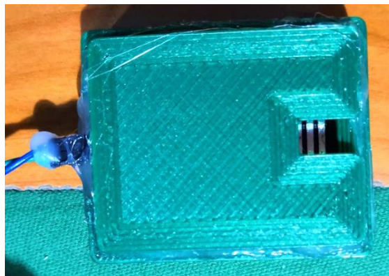
Figura 8.6. Carcasa con silicona
