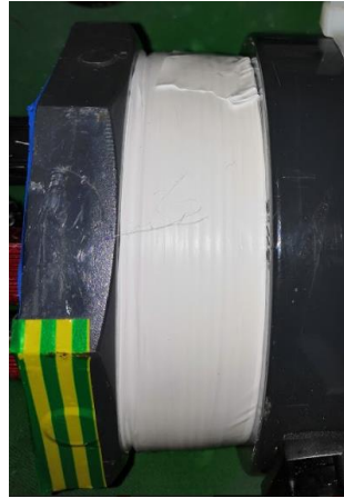
Figura 4.26. Teflón en la rosca del tapón
