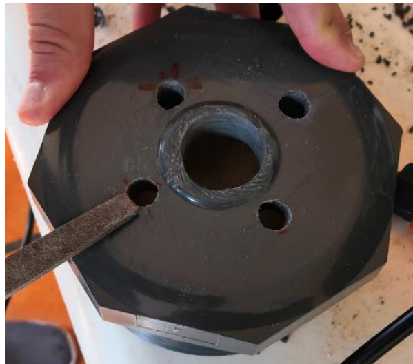
Figura 4.13. Alisado de la superficie taladrada
