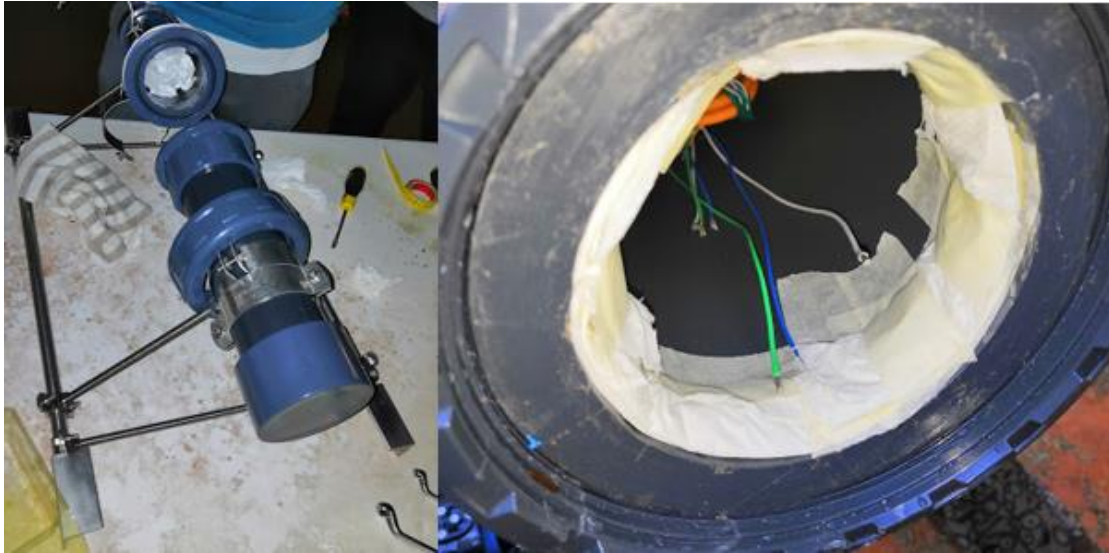
Figura 5.2. Sistema de comprobación de entrada de agua
