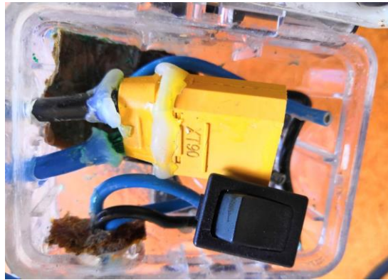
Figura 2.16. Terminales de carga e interruptor
