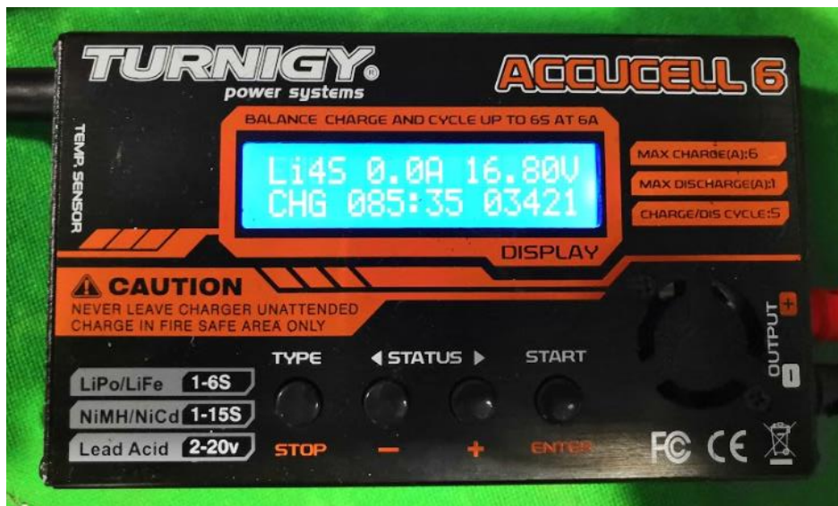
Figura 7.12. Proceso de carga finalizado
