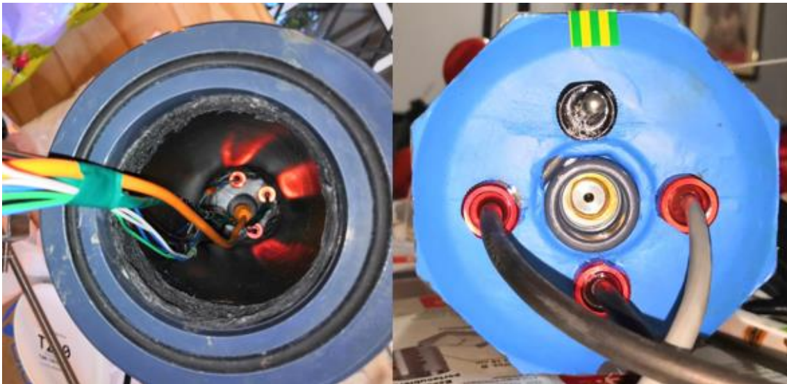
Figura 4.14. Cables pasados a través de los penetradores y sensor de presión
