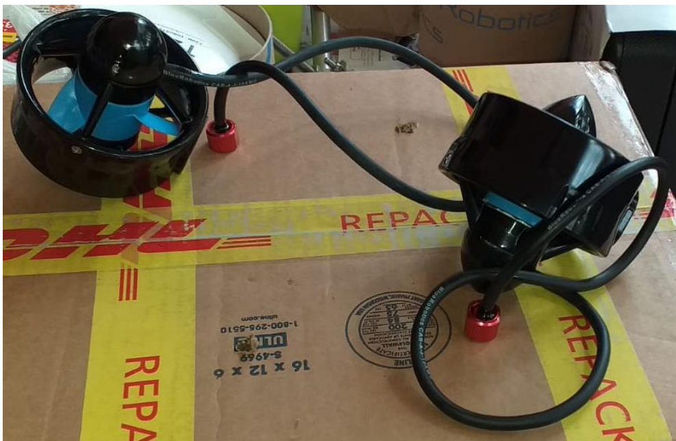
Figura 4.11. Penetradores con el cable de los motores
