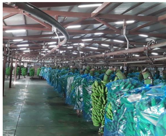
Figura 36: Estación de varias vías para su entrada a tren de lavado y desmanillado (Fuente: Propia)
