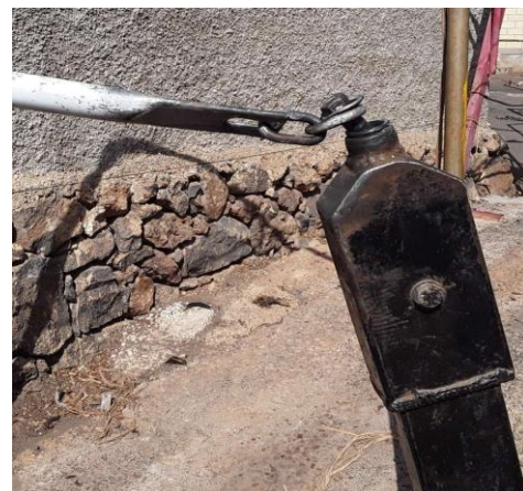
Figura 30: Detalle de conexión de tractor a tren de racimos (Fuente: Propia)
