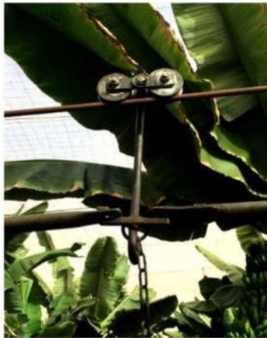
Figura 21: Garrucha con separadores y cadena de atado de racimos (Fuente: Propia)
