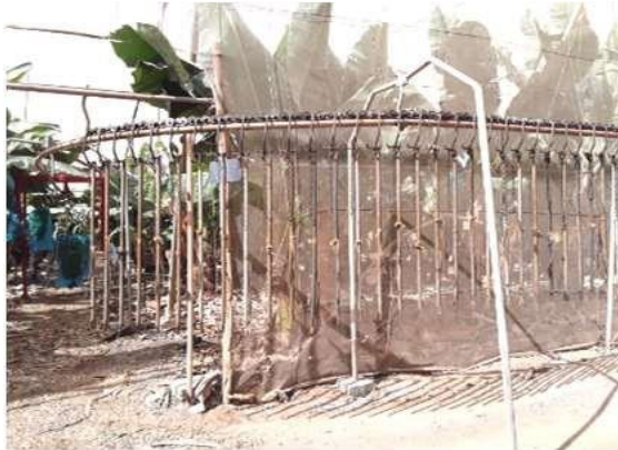
Figura 31: Garruchas y separadores hacia zona de recolección (Fuente: Propia)
