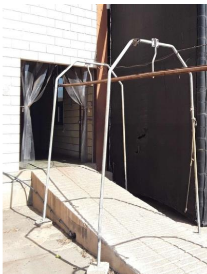
Figura 35: Cablecarril a la entrada del salón empaquetado (Fuente: Propia)
