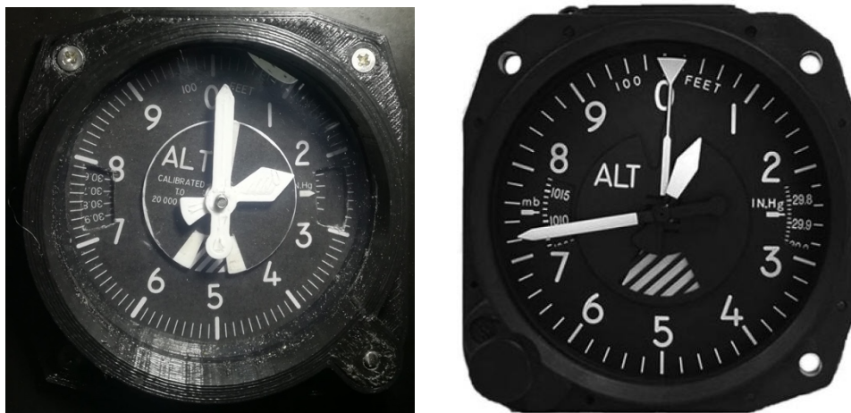
Figura IV.38. Altimetro fabricado y altímetro real de una avioneta.
