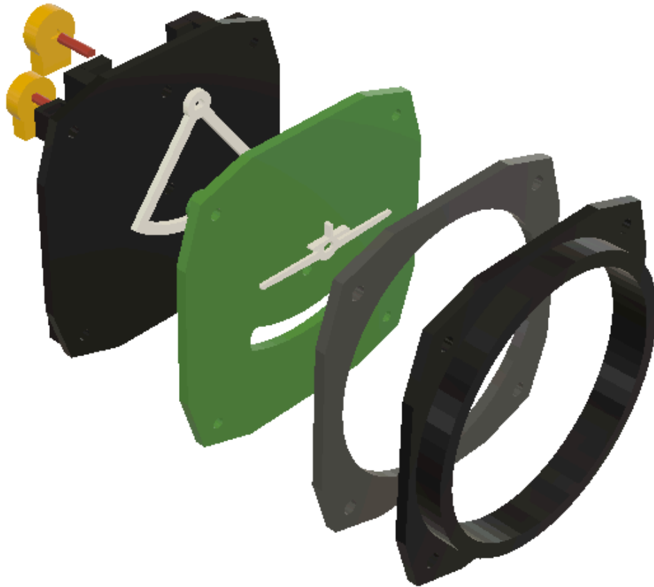
Figura IV.31. Ensamblaje del Turn-Coordinator.
