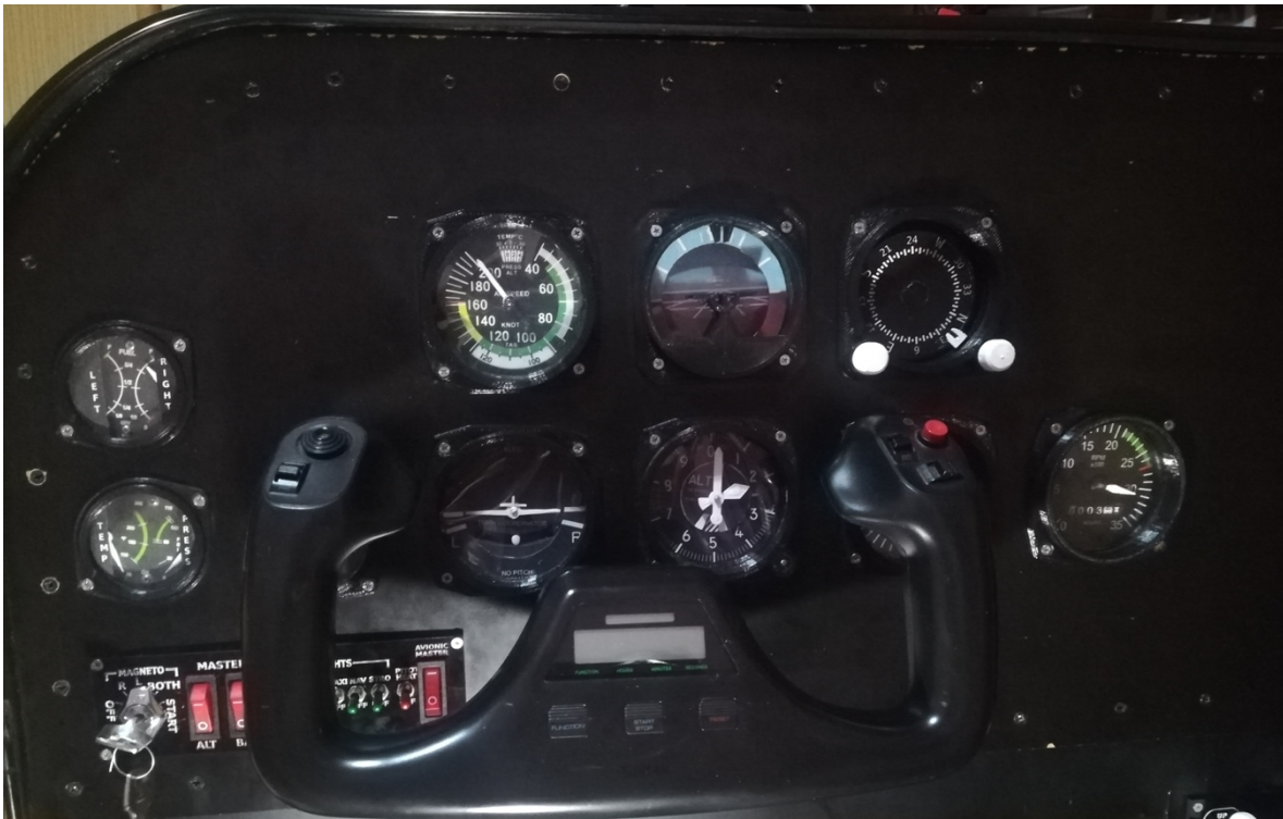
Figura VII.13. Gauges analógicos funcionando.
