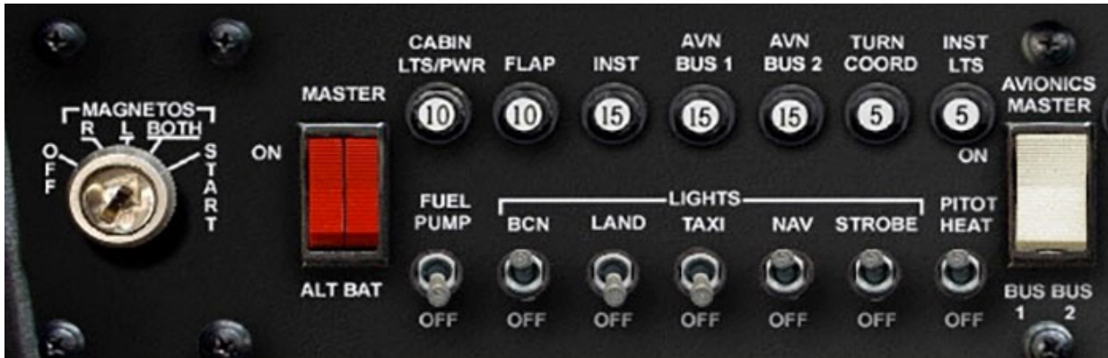
Figura IV.14. Conjunto de switches de una Cessna 172.
