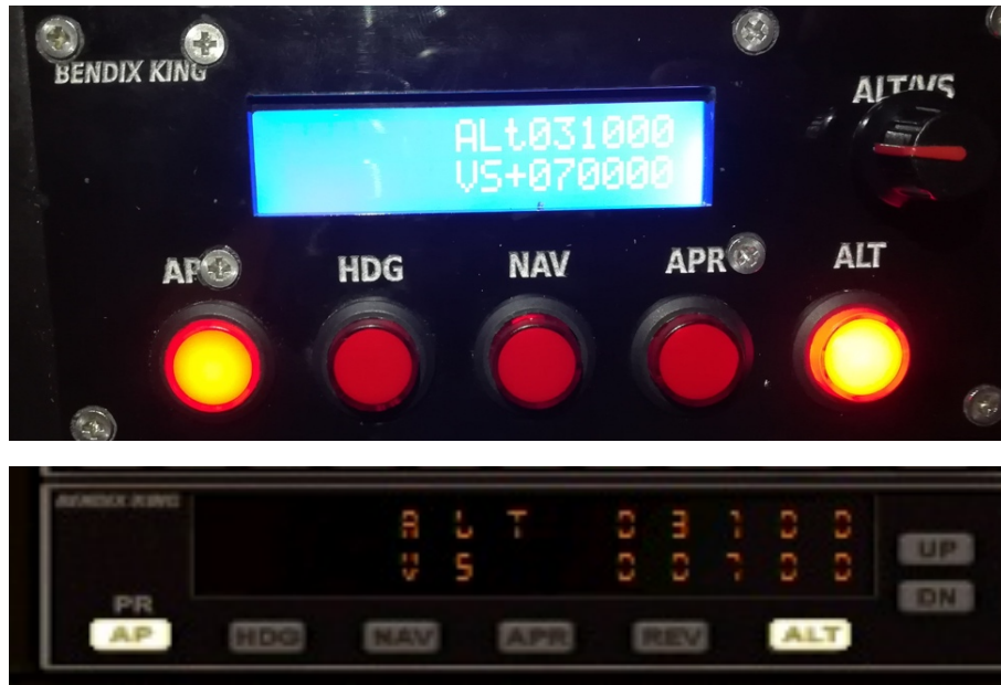
Figura VII.15. Panel del P.A. funcionando y sincronizado con FSX.
