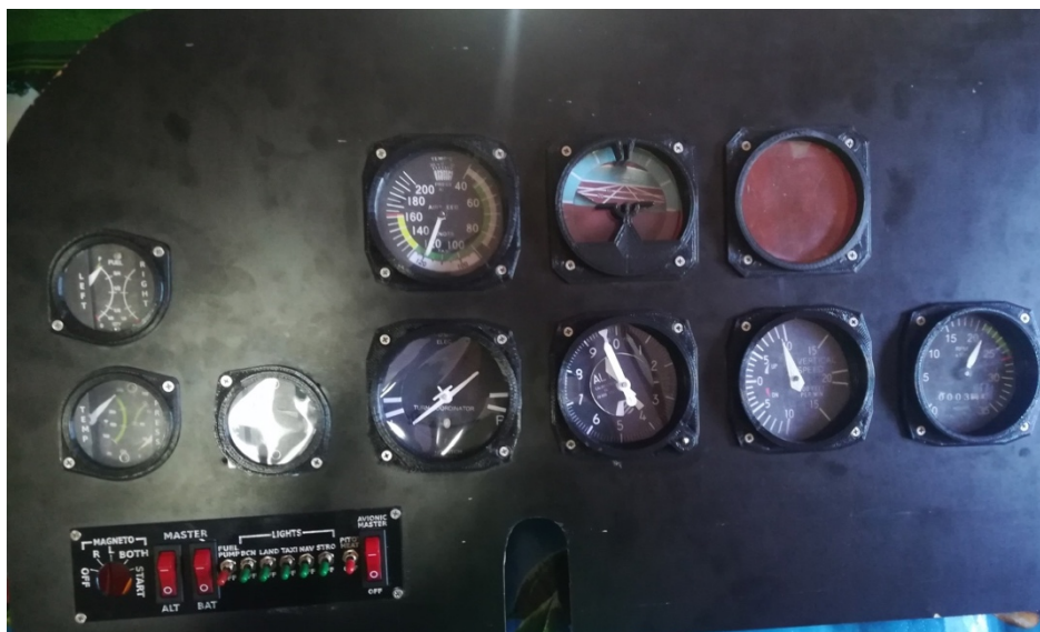
Figura VI.5. Disposición de los instrumentos en el salpicadero fabricado.
