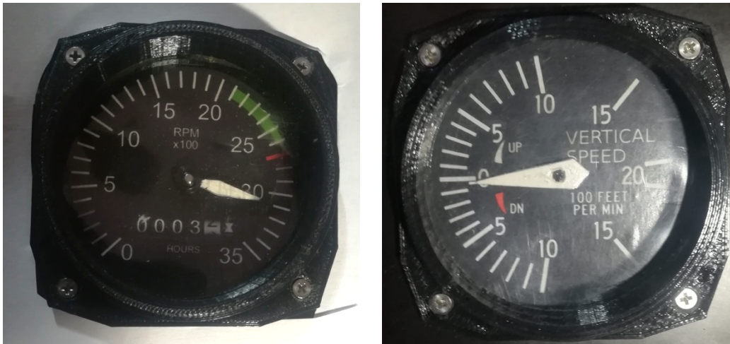
Figura IV.36. Instrumentos de RPM (A) y de velocidad vertical (B) fabricados.
