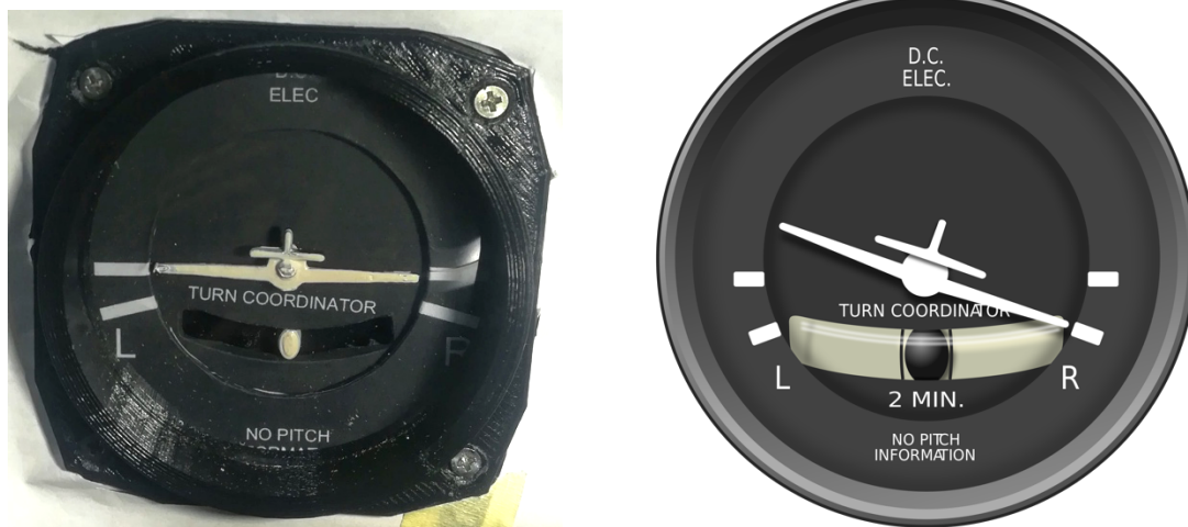
Figura IV.30. Aspecto del coordinador de giro fabricado y real.
