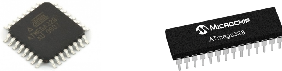
Figura II.3. ATmega 328 en formato SMD y en formato DIP de 28 pines.
