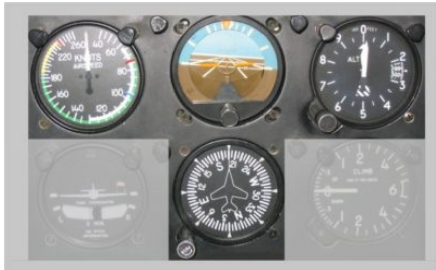
Figura VI.4. Disposición de los instrumentos en forma de T básica.
