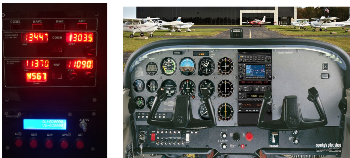
Figura VI.6. Parte derecha del salpicadero simulado (A) comparada con el real (B).
