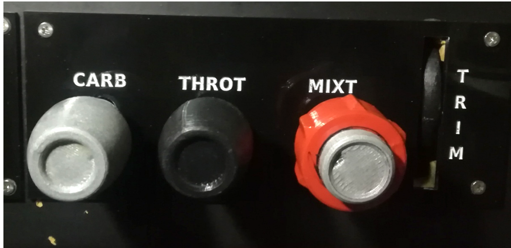
Figura IV.23. Panel de gases construido.
