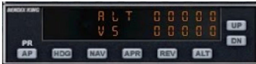
Figura IV.8. Panel del piloto automático de una Cessna.
