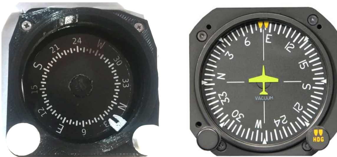
Figura IV.42. Indicador de rumbo fabricado frente al real de la Cessna.
