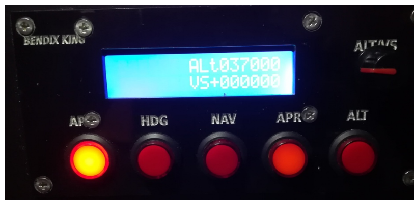
Figura VII.4. Panel de AP con el modo de aproximación activado.
