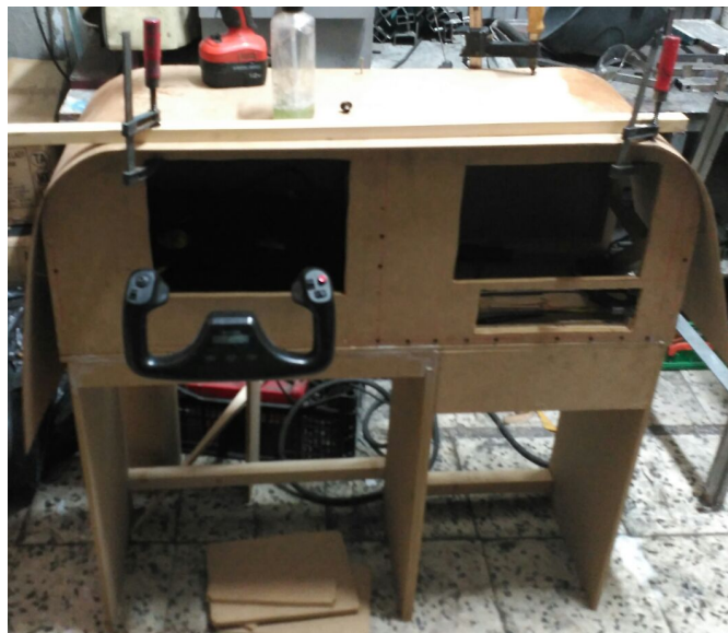
Figura VI.3. Salpicadero en proceso de fabricación.
