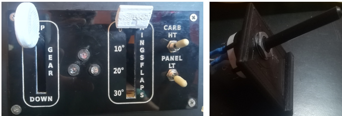
Figura IV.18. (A) Panel de tren diseñado. (B) Acople del eje al interruptor rotativo.
