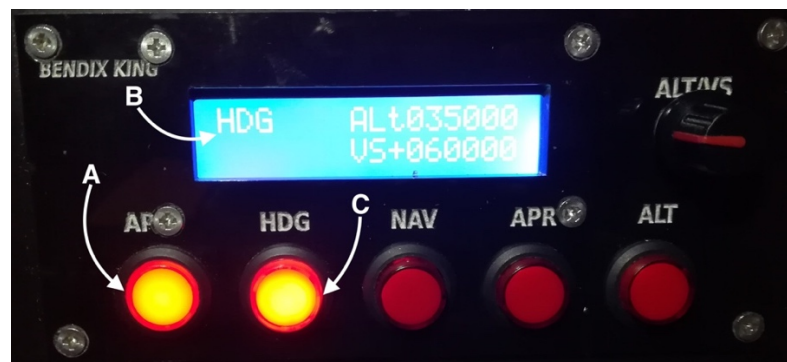
Figura VII.2. Uso del control de rumbo en el P.A.
