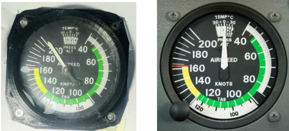
Figura IV.27. Aspecto del anemómetro fabricado y el real.
