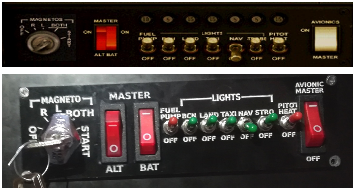
Figura VII.16. Panel de luces sincronizado con el simulador.
