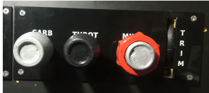
Figura VII.8. Rueda de ajuste de Trim situada en el panel de gases.
