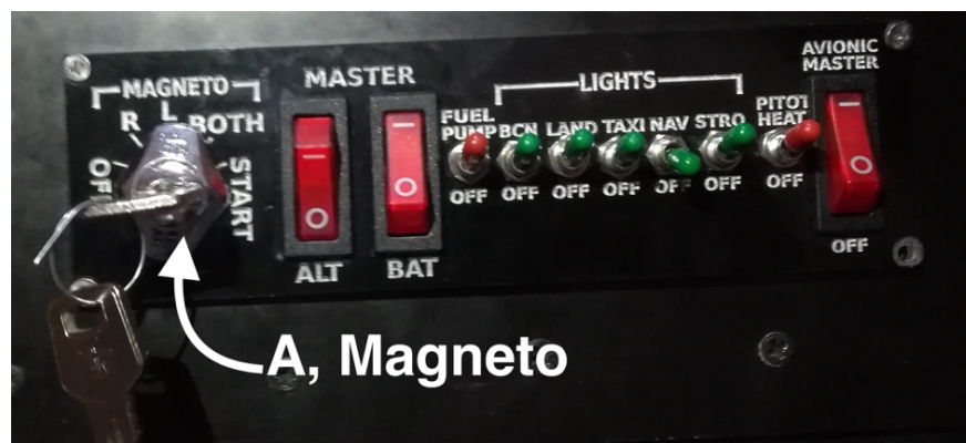
Figura VII.7. Magneto situado en el mando de luces.
