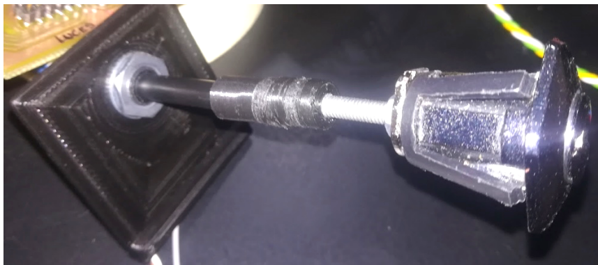
Figura IV.16. Mecanismo de llave para el magneto de arranque.
