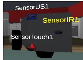
Figura 45: Etiquetas de sensores en el robot
