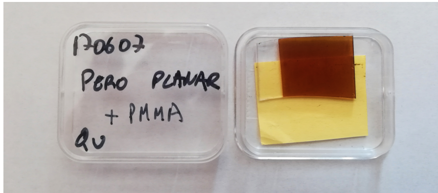
Figura 6: Muestra de perovskita compacta con recubrimiento de PMMA
