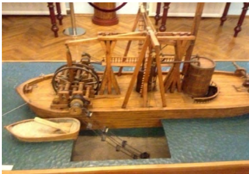
Figura 23b. Imagen de la draga de vapor para limpiar los fondos el puerto de Kronstadt inventada por A. Betancourt en 1810. Fotografía de la maqueta de la draga de Kronstad del Museo de A. Betancourt en la Universidad Estatal de Vías de Comunicación de San Petersburgo. Fuente: Autoría propia.
