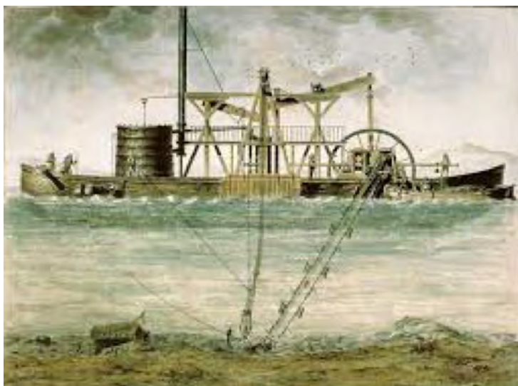
Figura 23a. Imagen de la draga de vapor para limpiar los fondos el puerto de Kronstadt inventada por A. Betancourt en 1810. Fuente: http://www.fundpushkin.org/agustin-de-betancourt/ .
