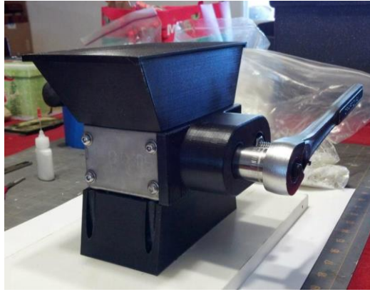
Figura 22: FilaMaker con elementos replicados en impresora 3D [18]
