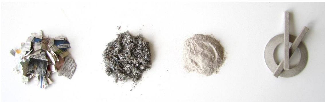
Figura 17: proceso de obtención de piezas impresas 3D en papel [27]
