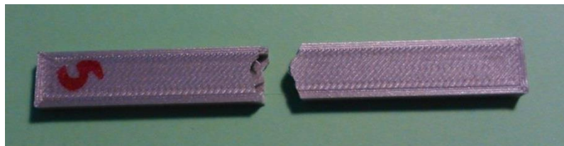
Figura 13: Probeta impresión 3D (PLA) tras ensayo de flexión [Fuente propia]
