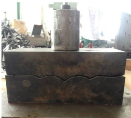
Figura 28: Patrón de conformado de la rejilla de corte [18]
