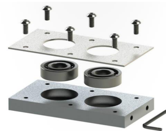
Figura 24: Montaje de los rodamientos Mini-trituradora FilaMaker [17]
