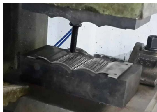
Figura 28: Patrón de conformado de la rejilla de corte [18]
