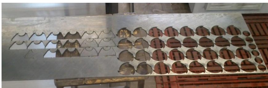
Figura 26: Fabricación de los discos de corte y las guías del material [18]
