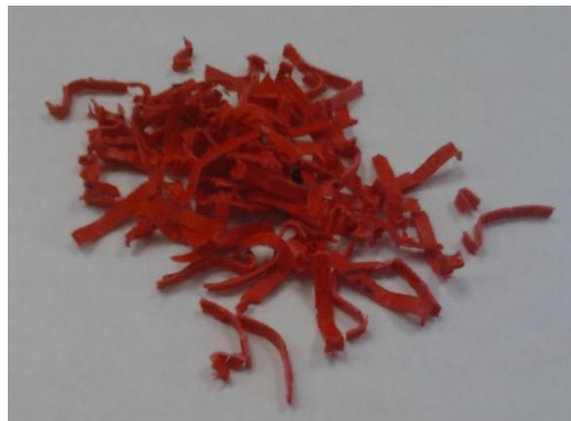
Figura 16: PLA triturado procedente de los cubos para ensayos compresión [Fuente propia]
