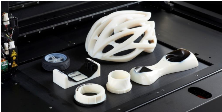
Figura 5: Piezas impresas con Objet Connex [33]
