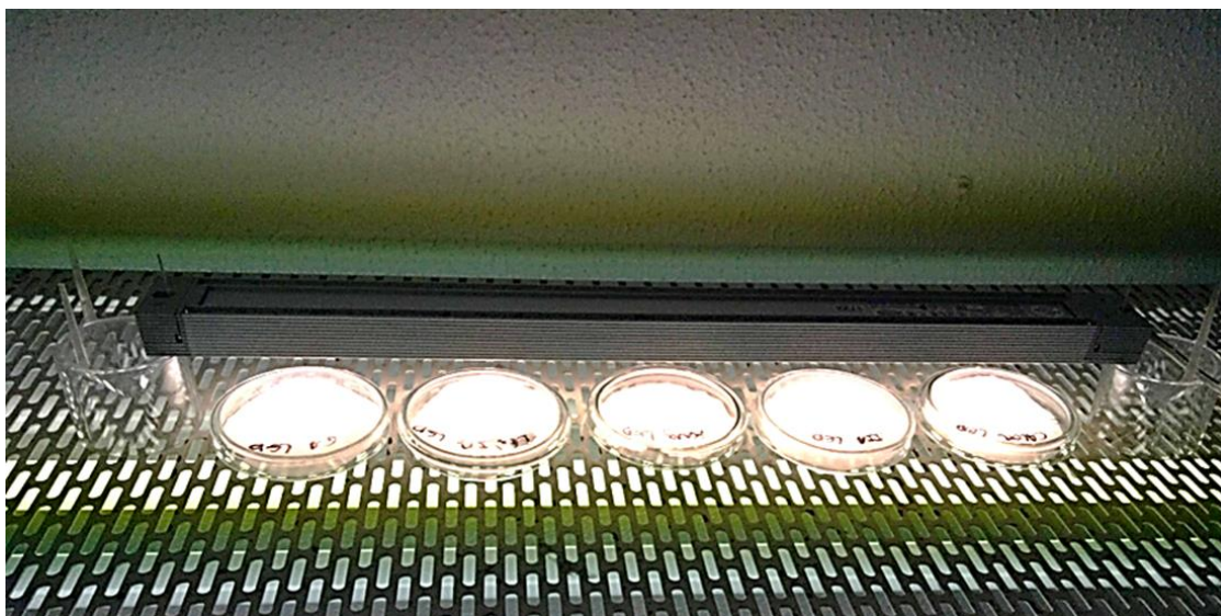
Figura 5: Detalle de los LED empleados en el ensayo 3, con una intensidad de luz de 1.000 ( \mu\text{mol}/\text{m}^2\text{s} )
