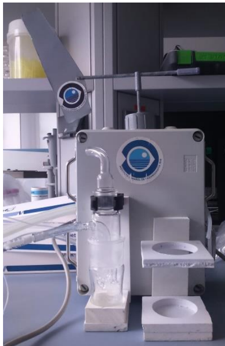
Fig. 2. SKC BioSampler en condiciones controladas en laboratorio del I.E.O. Tenerife.
