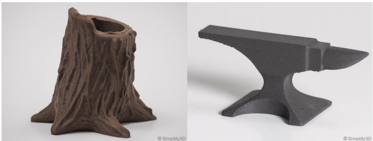
Figura 4.23: Piezas fabricadas con polvos de madera (izquierda) y metálicos (derecha).
