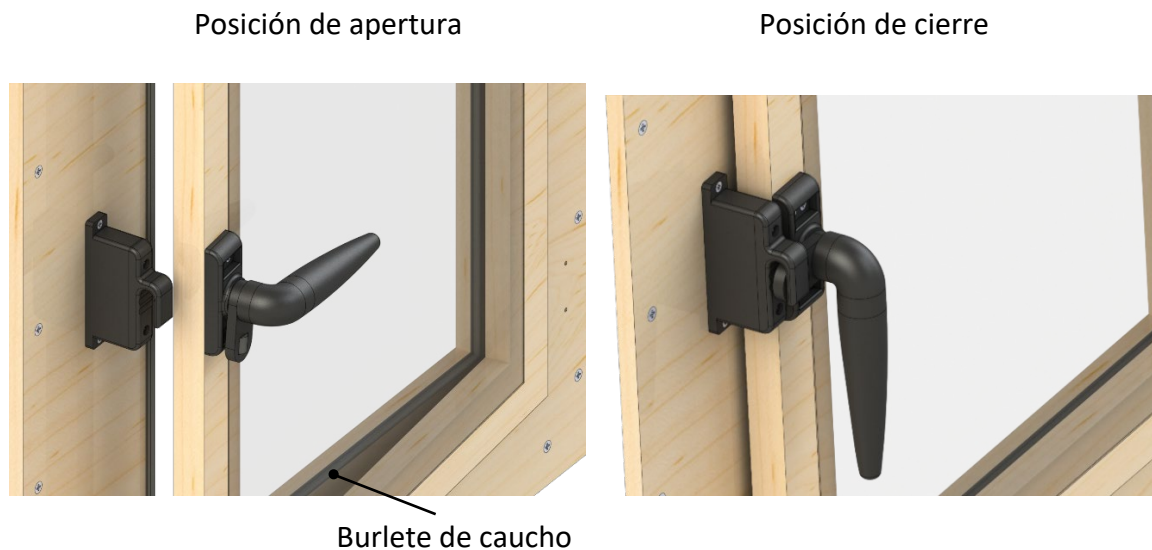
Figura 9.30: Funcionamiento de cierre a presión.
