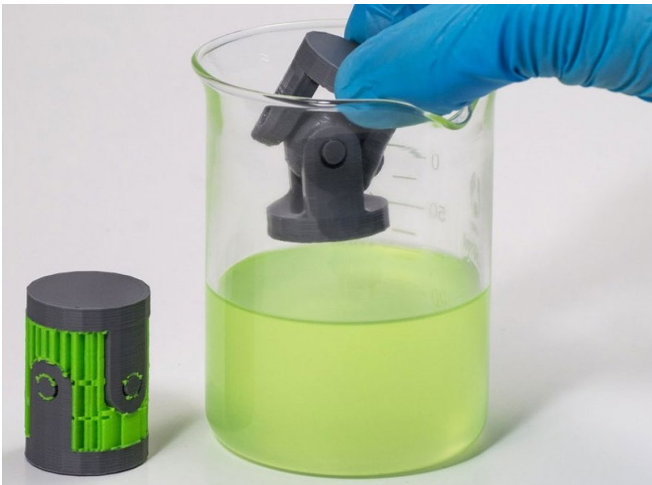
Figura 4.15: Uso combinado de HIPS y ABS para la creación de una pieza. Fuente: Simplify3D.
