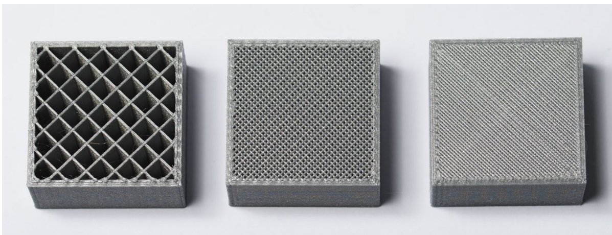
Figura 4.29: Porcentajes de relleno de piezas impresas mediante FDM.
