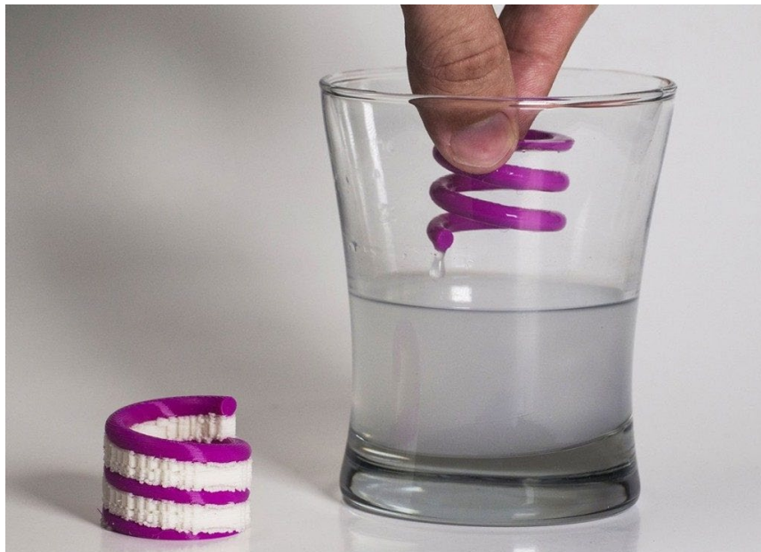
Figura 4.21: Ejemplo de disolución de soportes de PVA en agua caliente. Fuente: Simplify3D.
