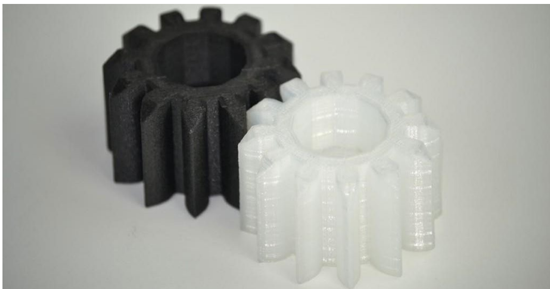
Figura 4.17: Ejemplo de utilización de nylon en FDM para fabricación de engranajes.
