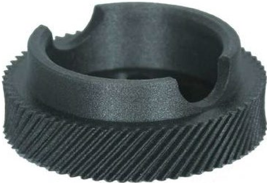
Figura 4.22: Pieza fabricada de nylon y fibra de carbono.
