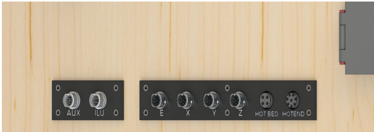
Figura 9.96: Conexiones eléctricas del recinto.
