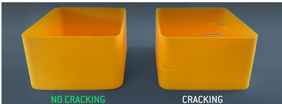
Figura 4.25: Efecto del Cracking en impresión FDM.
