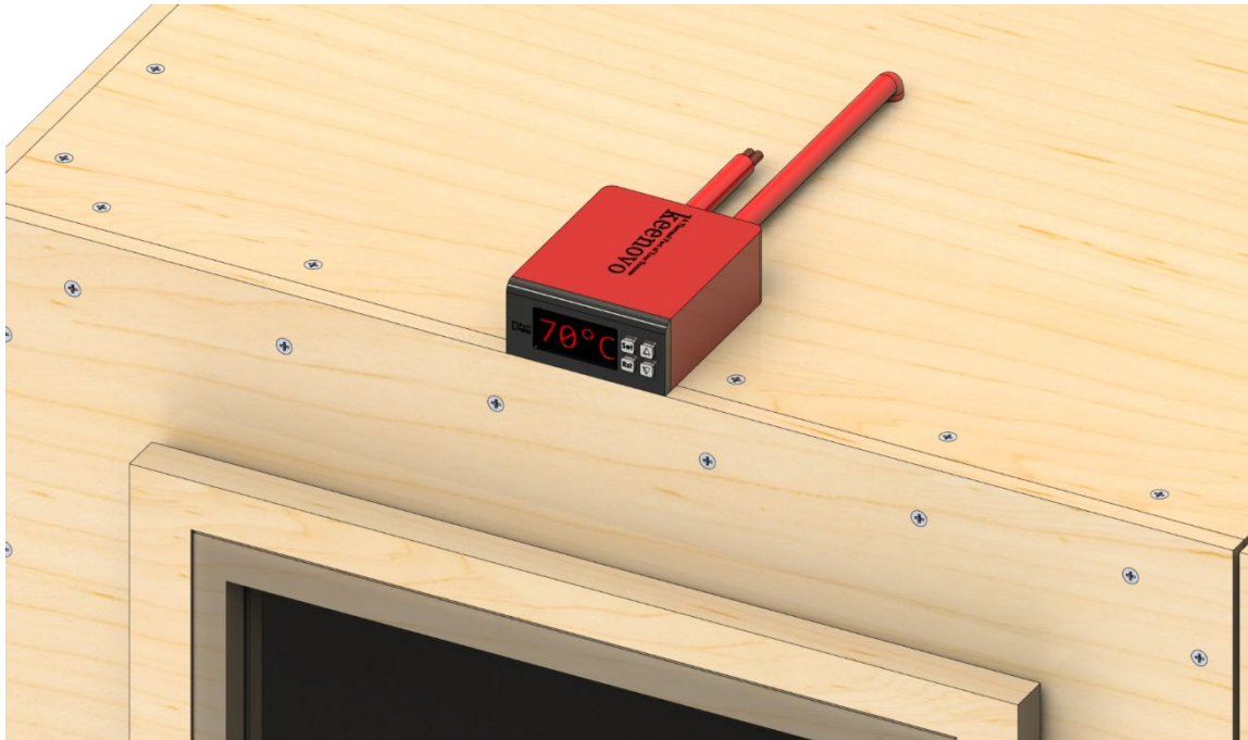
Figura 9.63: Colocación del controlador de temperatura keenovo.
