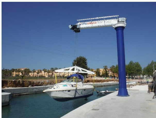
Imagen 2: Grúa pluma para puerto deportivo. Fuente: http://bit.ly/2K0YJXW
