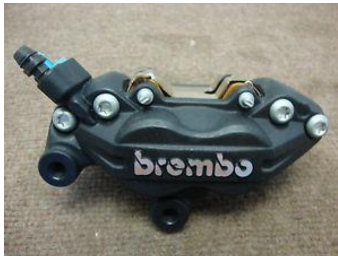
Figura 34. Pinza de freno tipo axial [34]
