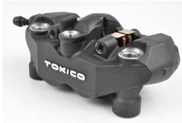
Figura 35. Pinza de freno tipo radial [17]
