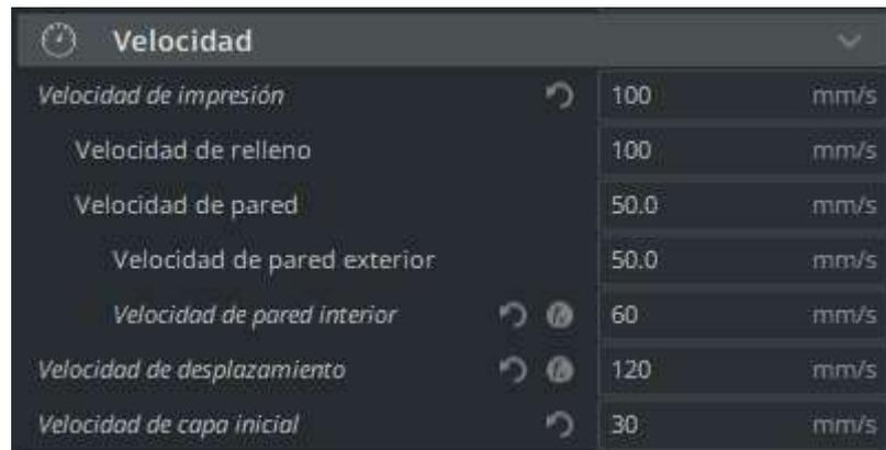
Figura 117. Velocidad de impresión 3D. Fuente propia
