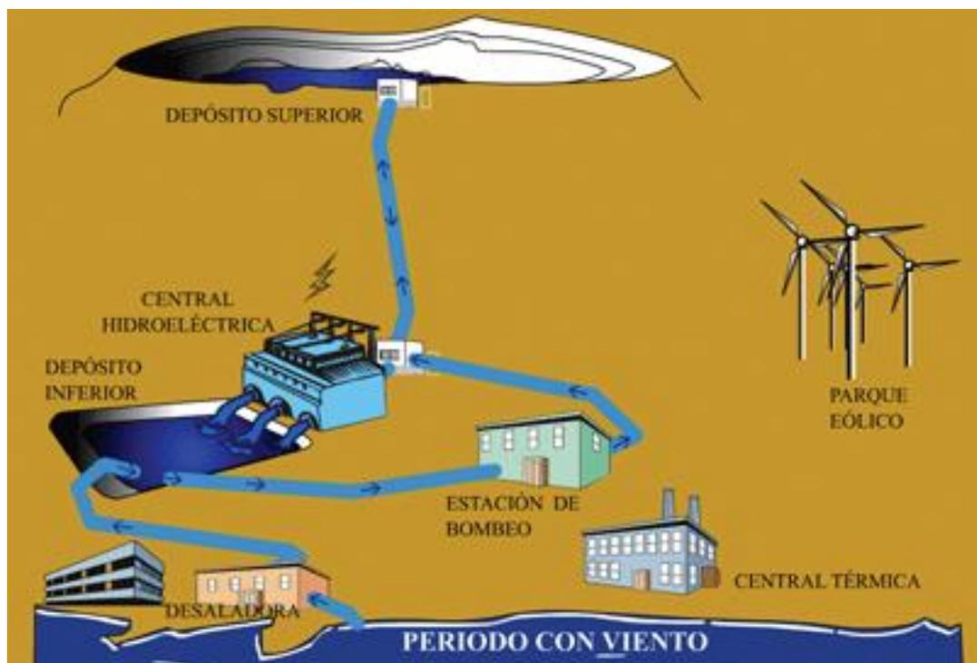
Figura 4. 6. Ejemplo central hidroeléctrica. Fuente: Noticias del Meridiano
