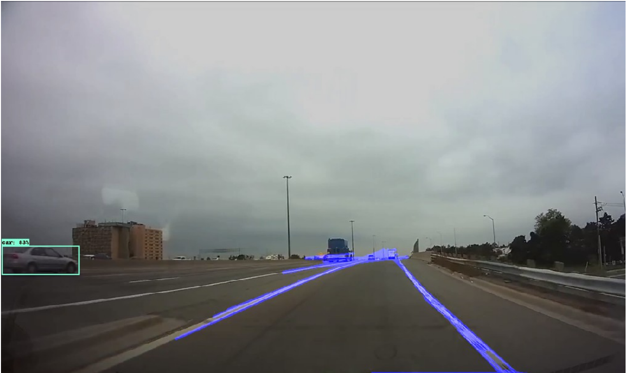
Figura 3.25: Nótese que la detección presenta una calidad y velocidad significativas, siendo detectado sin problema un coche que acaba de aparecer por un extremo de la imagen y en una zona oscura. Recordemos que la detección de carril se basa en la detección de bordes y sufre problemas en desniveles y curvas pronunciados, pero en situaciones controladas su desempeño no es despreciable como punto de partida.
