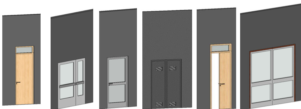
Figura 17: Esquema de carpintería - puertas modelado en BIM. Fuente: Elaboración propia.
