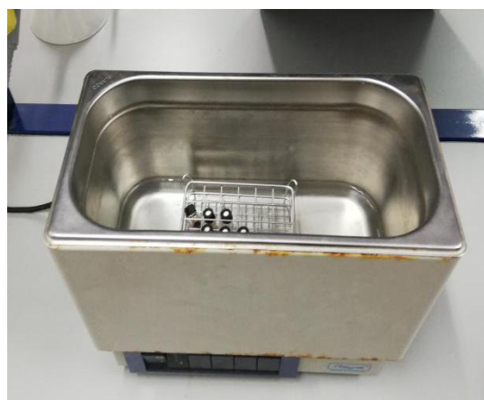
Figuras 42 y 43. Colocación del vial en la placa calefactora y en el sistema de ultrasonido empleado, respectivamente.
