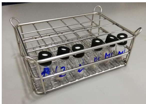
Figura 44. Viales con las muestras disueltas en 1mL de metanol.
