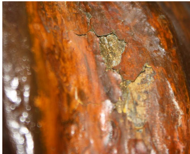
Figura 327. Falta de adhesión de los estratos.
