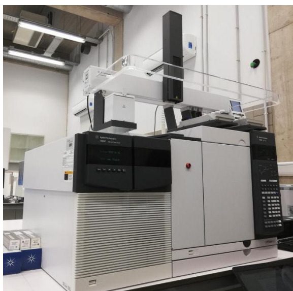
Figura 46. Cromatógrafo de Gases Modelo 7890B- Espectrómetro de Masas modelo 7000C con inyector automático robotizado Combipal de AGILENT Technologies
