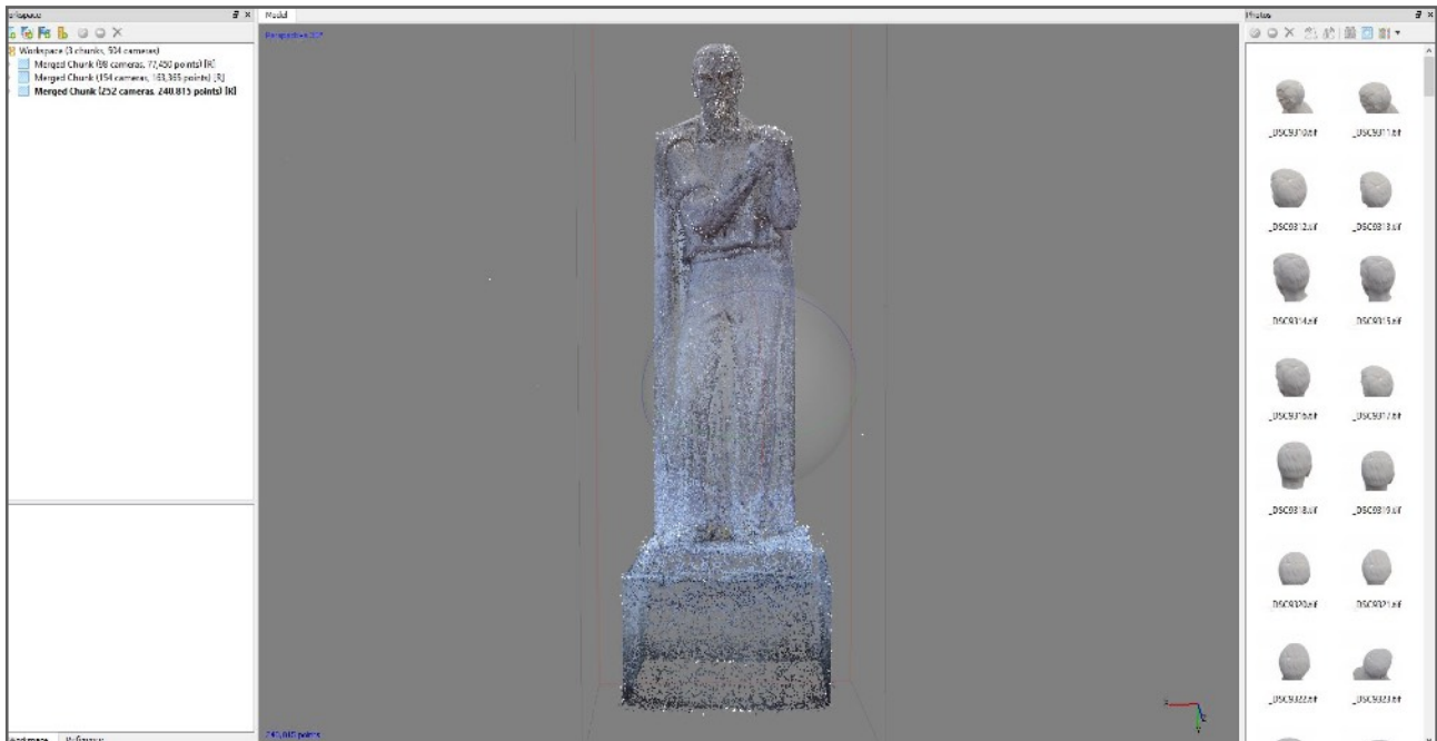
Fig. 23. Chunks alineados hasta nube de puntos sencilla
