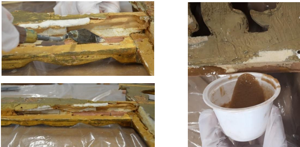
Figuras 141-143: Creación de las barreras de Axson® y vertido de la resina epoxi líquida con serrín claro fino.
