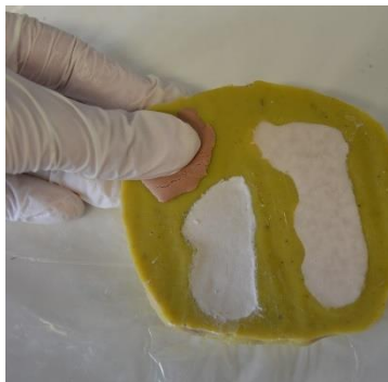
Figura 185: Creación de pieza apretando con Axson®.
