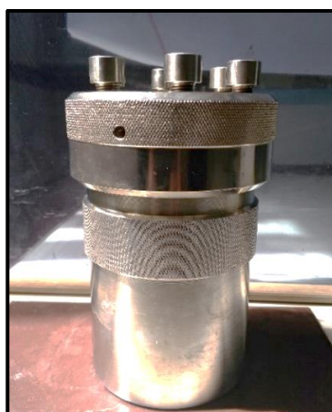
Figura 10. Autoclave empleado en las síntesis.
