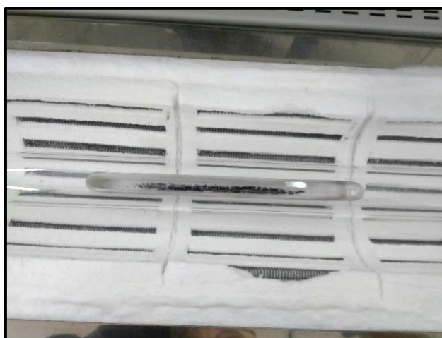
Figura 11. Muestra en una barquilla de cerámica en el horno tubular .
