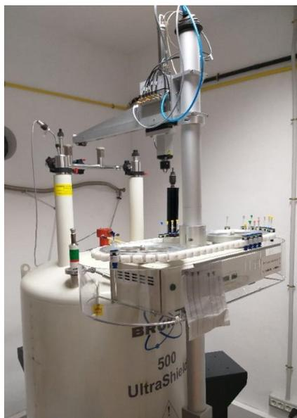
**Imagen 3.** Espectrómetro Bruker Avance II 500
