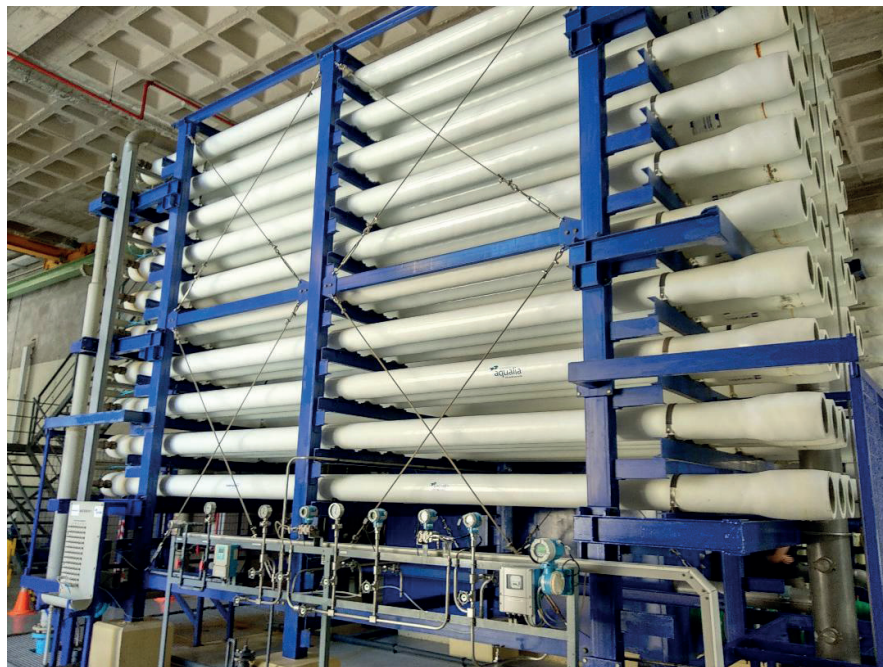
Figura 2.2. Bastidor de una planta desalinizadora de agua de mar
