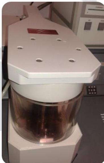
Figura 1. Cámara y cabezal para el recubrimiento con plata.
