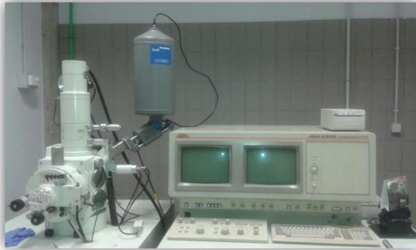
Figura 2. Microscopio electrónico de barrido JEOL JSM 6300.
