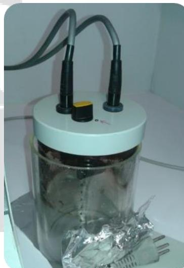
**Figura 4.** Cabezal de la unidad de evaporación de carbono.
