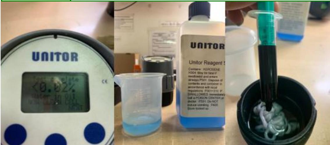
Ilustración 32. Análisis de %H2O en aceite. 1 Resultado correcto de % de H2O. 2 Reactivo del análisis. 3 Preparación del análisis. Fuente: Trabajo de campo.
