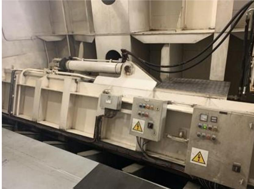
Ilustración 33. Estabilizador de babor. Fuente: Trabajo de campo
