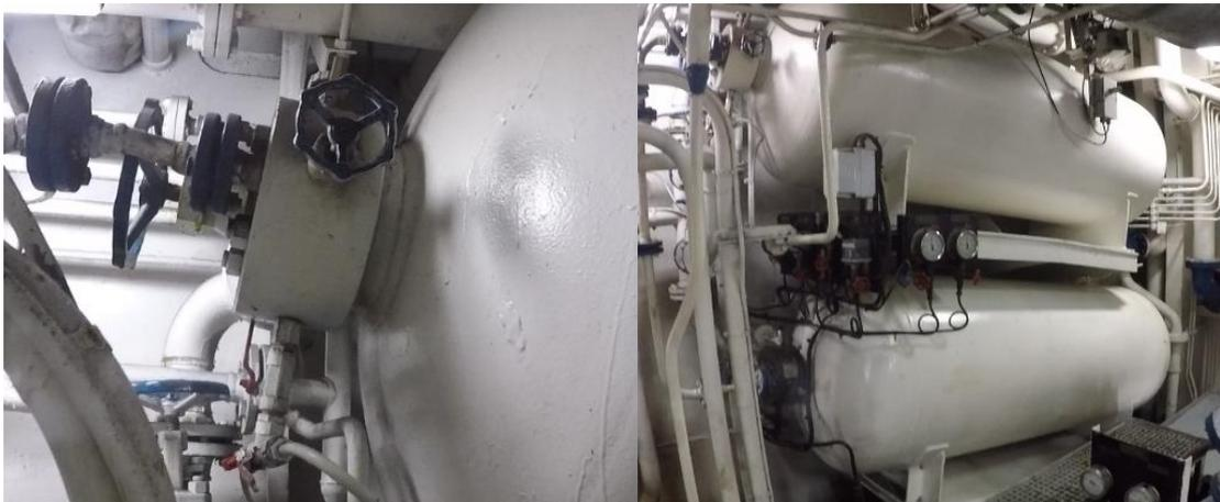
*Ilustración 18. Botellas de aire de arranque M.M.P.P. y Botellas de aire de arranque M.M.P.P.
