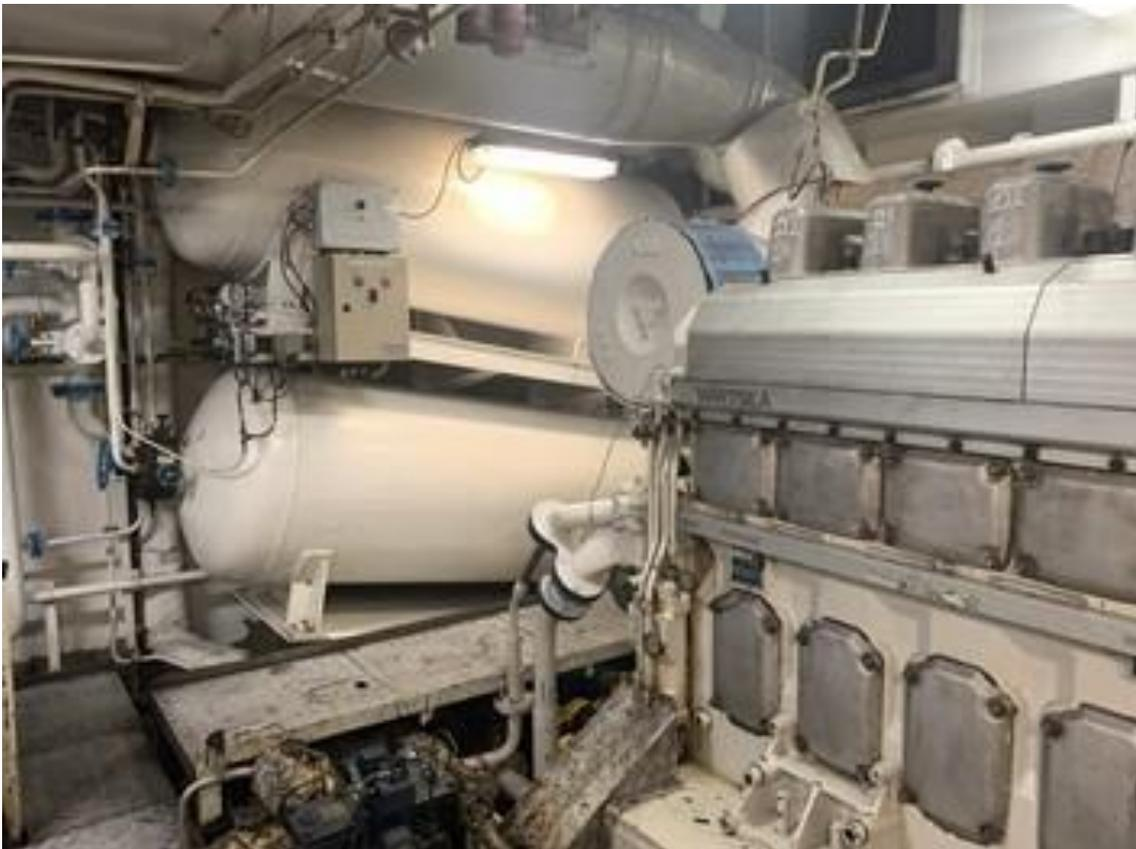
*Ilustración 46. Bombona de aire comprimido de MMPP Fuente: Trabajo de campo.*
