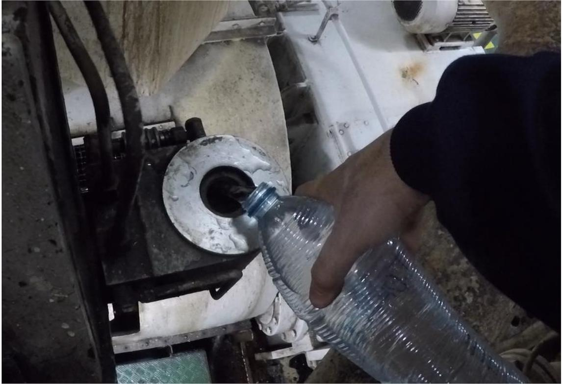
*Ilustración 15. Rellenado de agua destilada para la limpieza de la turbo. Fuente: Trabajo de campo.*
