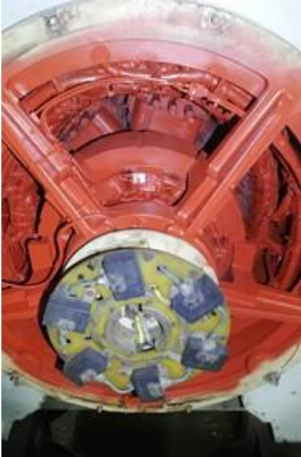
*Ilustración 45. Comprobación del estado interno de los generadores de cola. Fuente: Trabajo de campo.*
