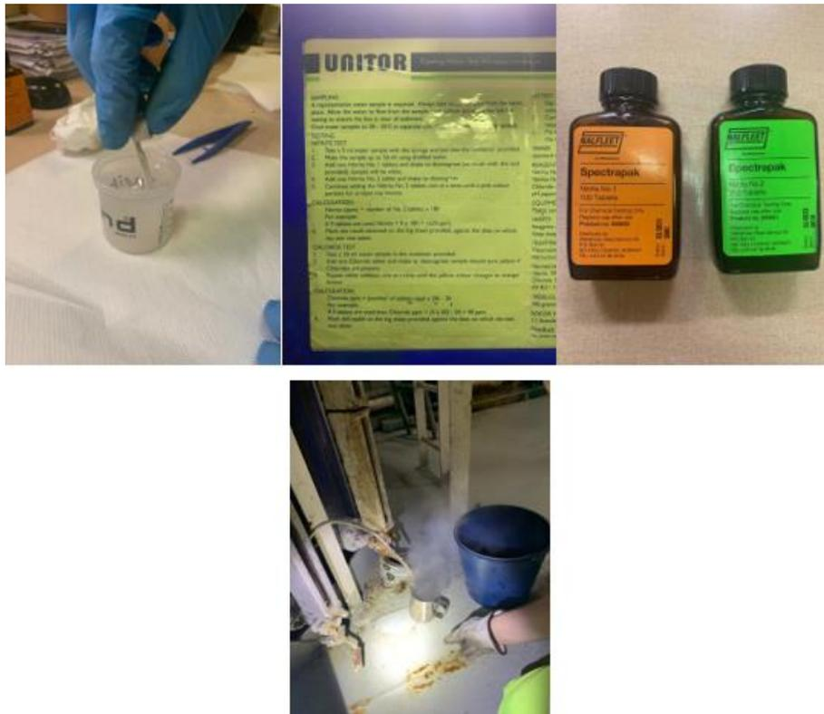
Ilustración 31. Análisis de agua: 1. Mezcla agua-reactivo. 2 Instrucciones de procedimiento. 3 Reactivos. 4 Toma de muestra de agua de caldera. Fuente: Trabajo de campo.
