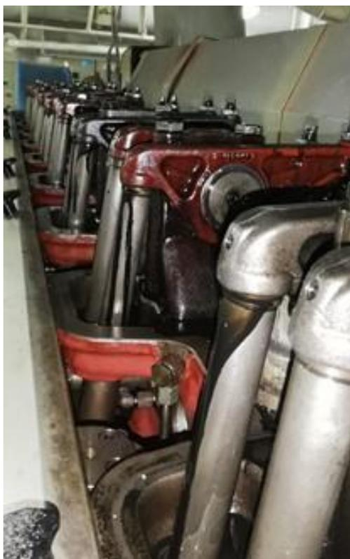
Ilustración 44. Reglaje de válvulas de M.M.A.A. Fuente: Trabajo de campo
