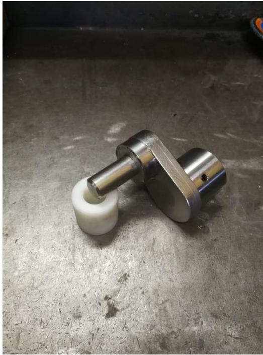
Ilustración 29: Rodillo nylon y pasador.
