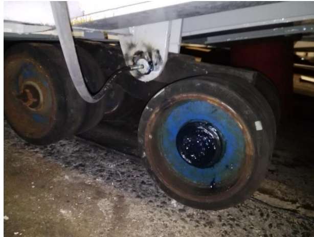
Ilustración 72: Patín derecho y latiguillo.
