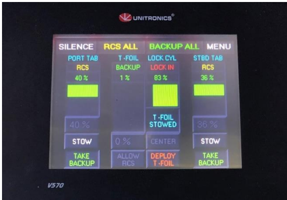
Ilustración 18- Pantalla Unitronics para operar el T-Foil. Fuente: Elaboración Propia
