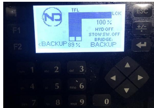
Ilustración 20- Pantalla para Operar el T-Foil. Fuente: Elaboración Propia
