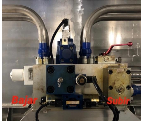
Ilustración 21- Válvula Solenoide T-Foil. Fuente: Elaboración Propia
