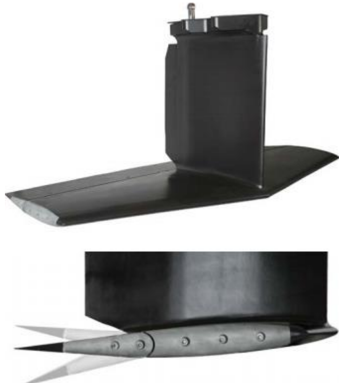
Ilustración 8- T-Foil Activo (con flap)
