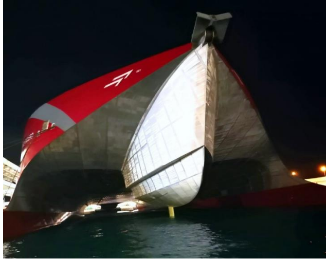
Ilustración 15- Proa del Volcán de Tagoro con el T-Foil arriado. Fuente: Elaboración propia
