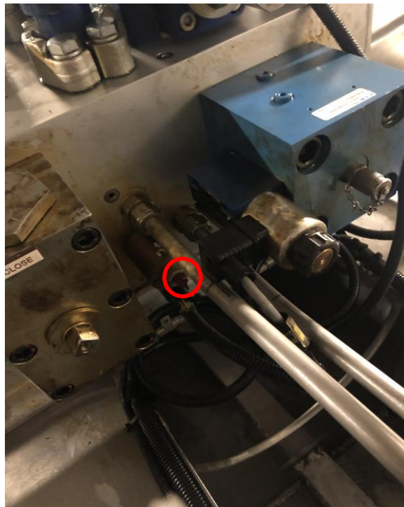
Ilustración 22- Pin de trincaje del T-Foil en Válvula Solenoide. Fuente: Elaboración propia
