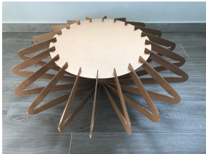
Figura 32. Fabricación de una posible propuesta en cartón "ensamblado". Fuente: elaboración propia
