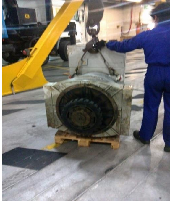
Imagen nº 137. Acomodación del alternador sobre cubierta de carga.
