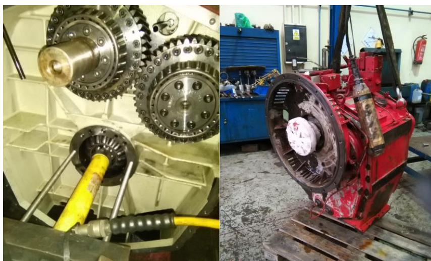
Imagen nº 129. Reparación de reductora.
