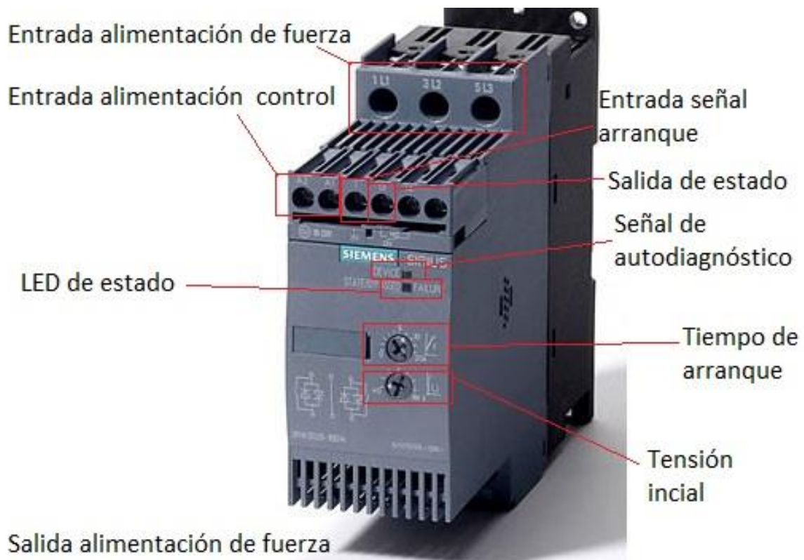
Imagen nº 107. Partes de un arrancador suave.
