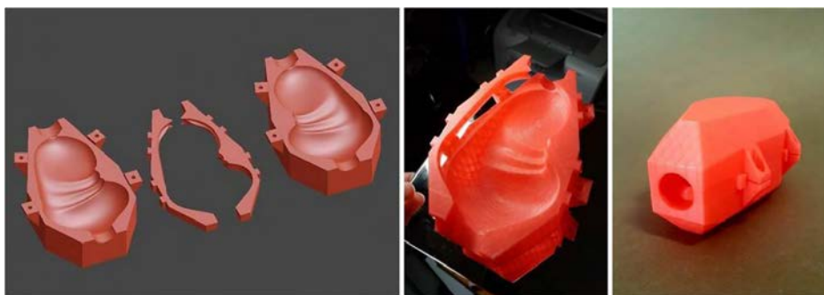
Figura 4. Molde a piezas (reutilizable). La construcción y el despiece de la forma se llevaron a cabo con software Blender.
