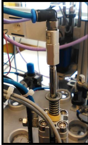
Figura 3.8 Válvula que activa al elemento vertical
