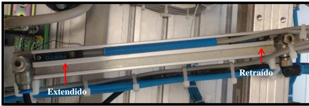
Figura 3.6 Sensores del elemento horizontal
