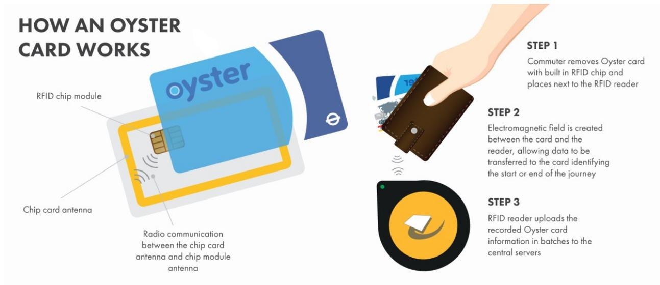
Figura 2.3: Esquema de funcionamiento de la Oyster card.
