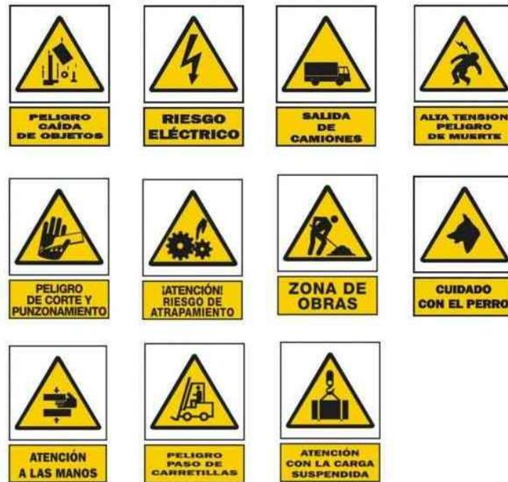
Imagen 21: Señalización de advertencias.
