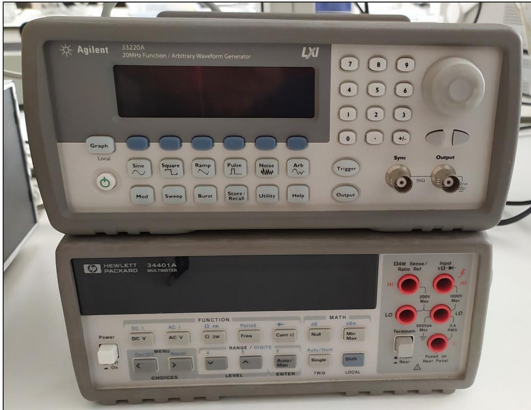
Figura 22. Generador de funciones *Agilent 33220A* y Multímetro Digital *HP 34401A*
