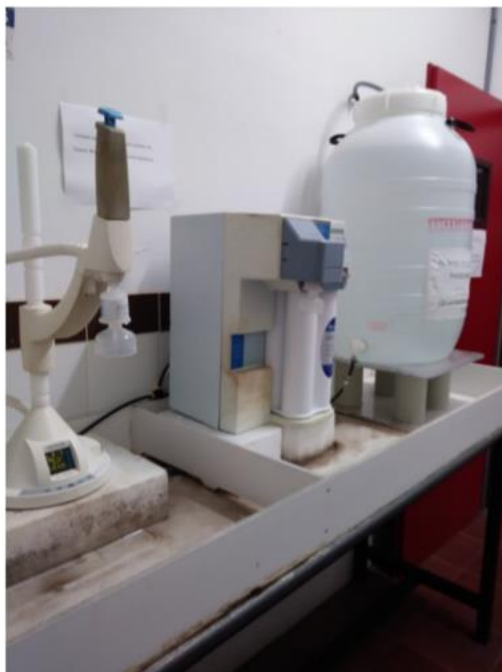
Figura 6. Sistema de purificación Millipore Q-Pod ®
