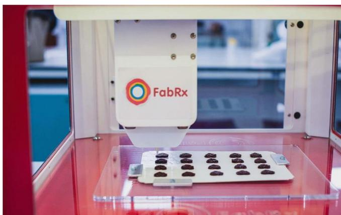
[Figura 16]. Proceso de fabricación de imprimido empleando SSE. Ejemplo de producción de imprimidos con características organolépticas similares a las de una gominola. Fuente: Extracto de video promocional de la empresa *FabRx*. Referencia en los anexos <sup>(7)</sup>
