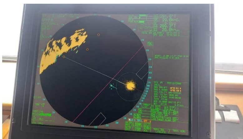
ILUSTRACIÓN 2: IMAGEN DE RADAR DE UN BUQUE CRUZANDO UN DISPOSITIVO DE SEPARACIÓN DE TRÁFICO.
