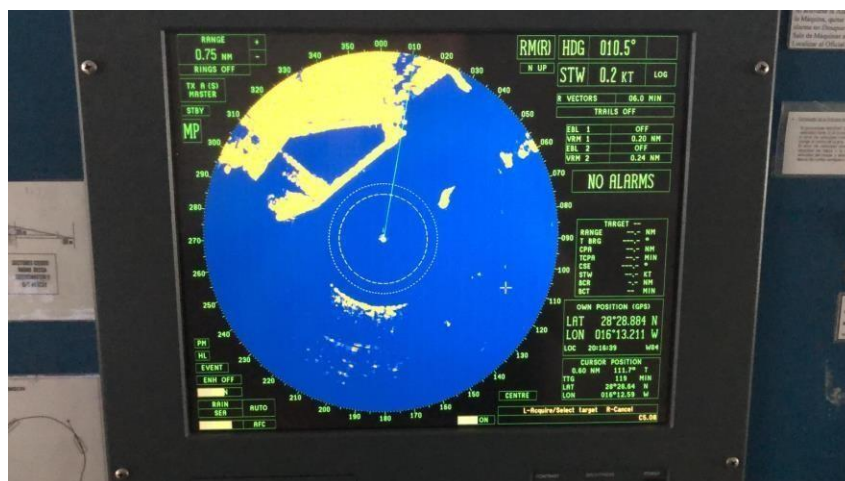
ILUSTRACIÓN 12: IMAGEN DE RADAR CON SUS ANILLOS PARA LA ALARMA DE FONDEO DE UN BUQUE FONDEADO.
