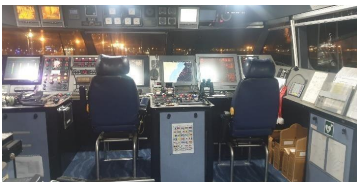
ILUSTRACIÓN 13: IMAGEN DE UN PUENTE DE MANDO DE UNA NAVE DE GRAN VELOCIDAD .
