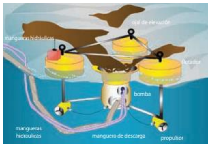
Ilustración 19: "Skimmer de tipo vertedero: tiene la boca de aspiración en el interfaz agua-hidrocarburo de manera que, por gravedad, se aspira el hidrocarburo dirigiéndose al tanque de almacenamiento gracias a la actuación de una bomba que lo impulsa" 16
