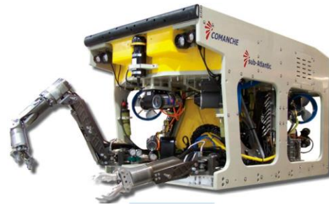
Ilustración 23: "ROV submarino de intervención COMANCHE"
