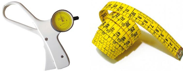
*Figura 3: Plicómetro y cinta antropométrica empleada en el estudio [36]*
