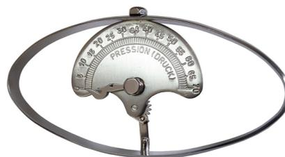
*Figura 4: dinamómetro manual empleada en el estudio [36]*
