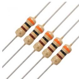
Ilustración 26: Resistencias de película de carbón.
