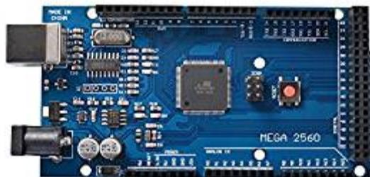
*Ilustración 40: Arduino MEGA 2560.*
