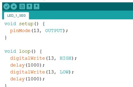
En este punto ya estaría cargado el código en la memoria del microcontrolador y mientras el Arduino reciba alimentación el LED debe encenderse y apagarse en intervalos de un segundo según el programa introducido.
