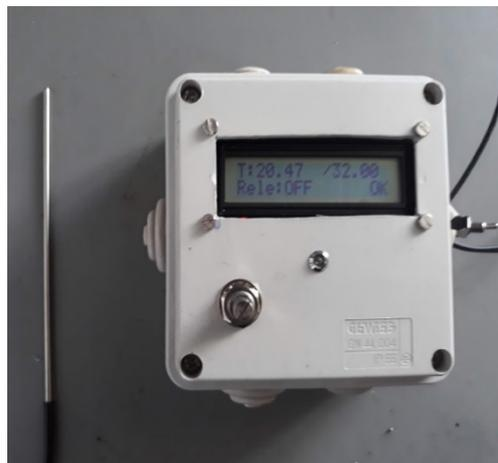
Ilustración 57: Aspecto final del Termostato Digital de Control
