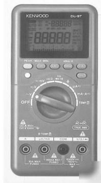
Ilustración 44: Multímetro Digital Kenwood DL-97.
